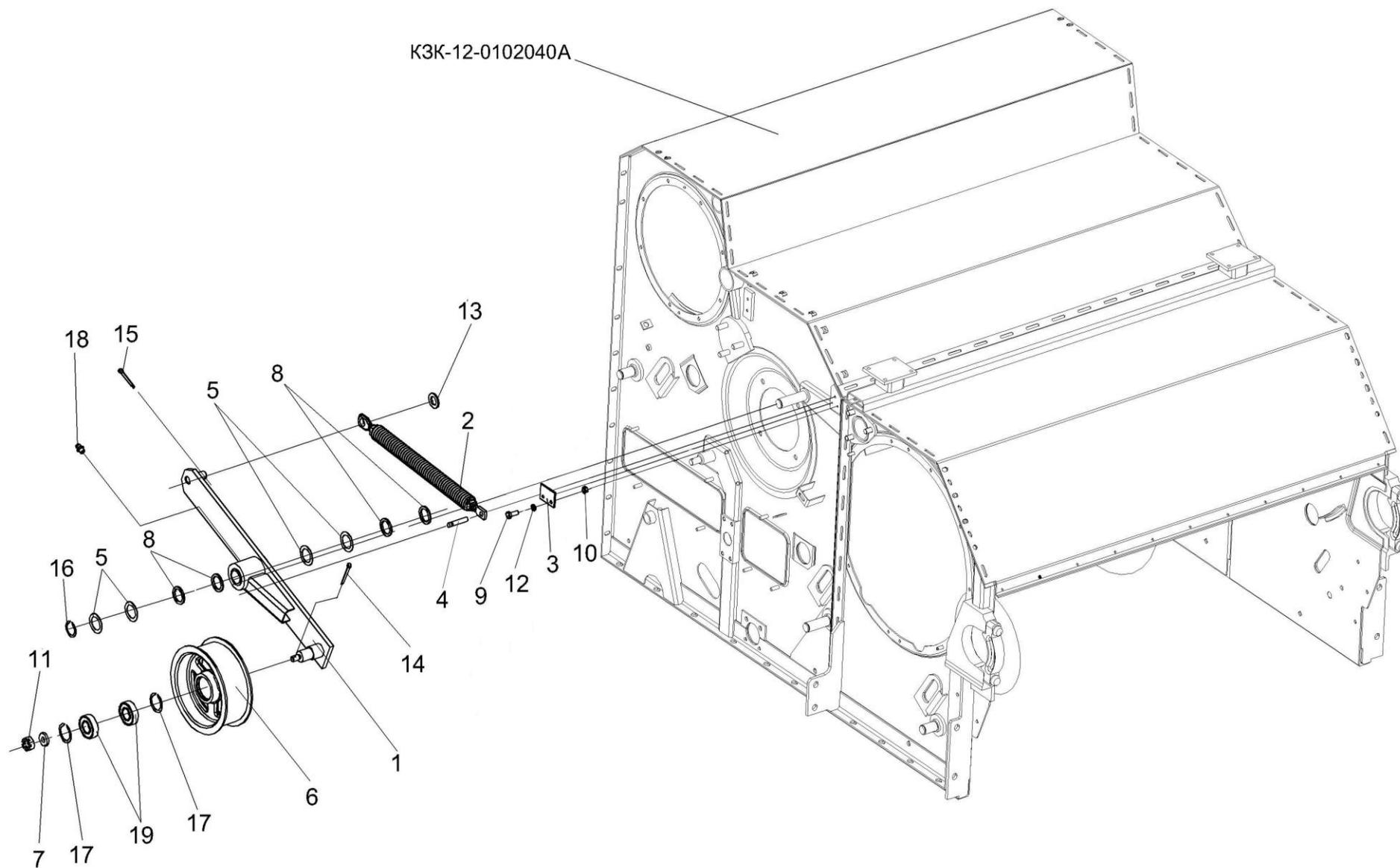
Рисунок 57 – Аппарат молотильный КЗК-12-1-0102000 (привод отбойного битера)
