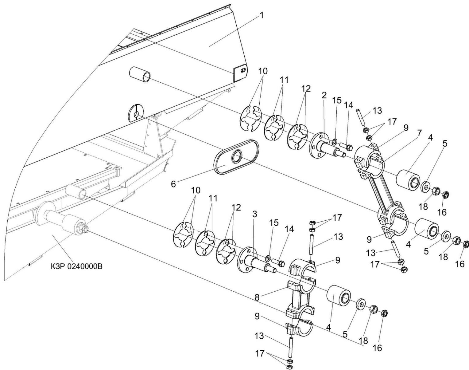
Рисунок 46 – Установка привода стана решетного верхнего КЗК-10-0260000
