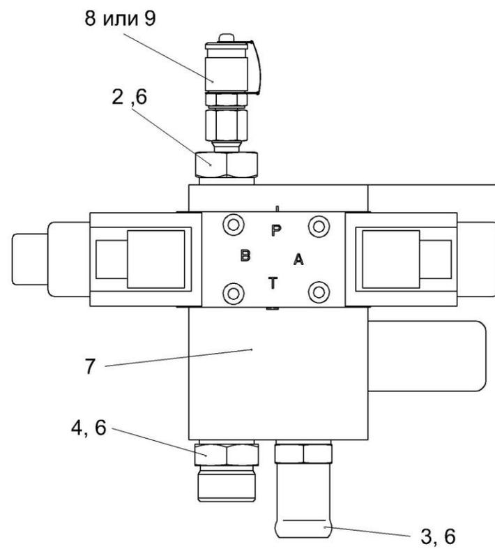
Рисунок 230 – Гидроблок односекционный КЗК-12-0602670
