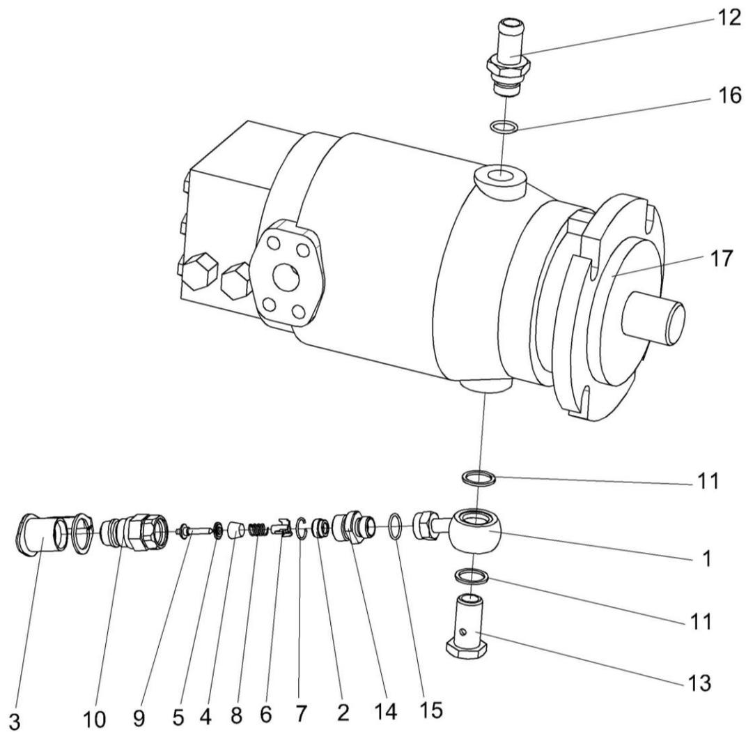
Рисунок 216 – Гидромотор КЗК-12-0601230
