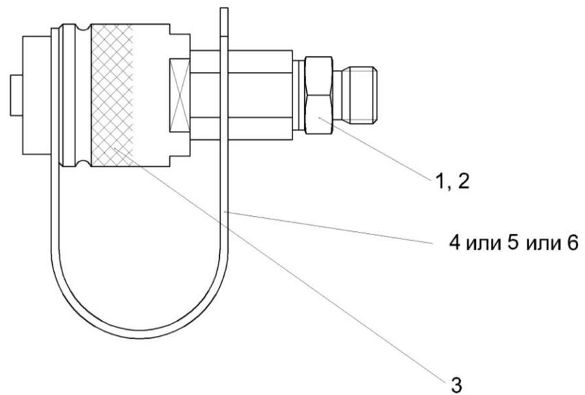
Рисунок 224 – Полумуфты молотилки КЗК-12-0602090, КЗК-12-0602090-01, КЗК-12-0602090-02
