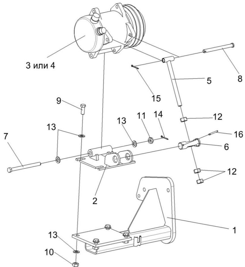
Рисунок 140 – Компрессоры КЗК-12-0113070А и КЗК-12-0113070А-01
