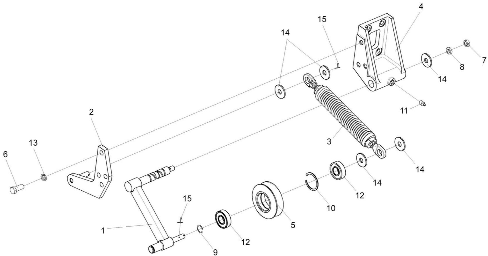
Рисунок 200 – Устройство натяжное КЗК-10-0112010
