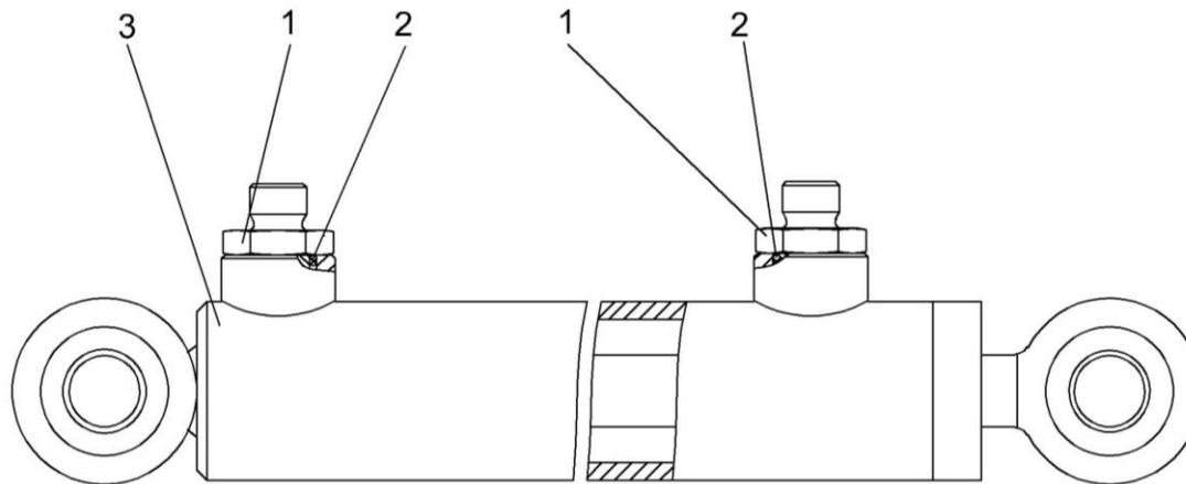
Рисунок 225 – Гидроцилиндр КЗК-12-0602310
