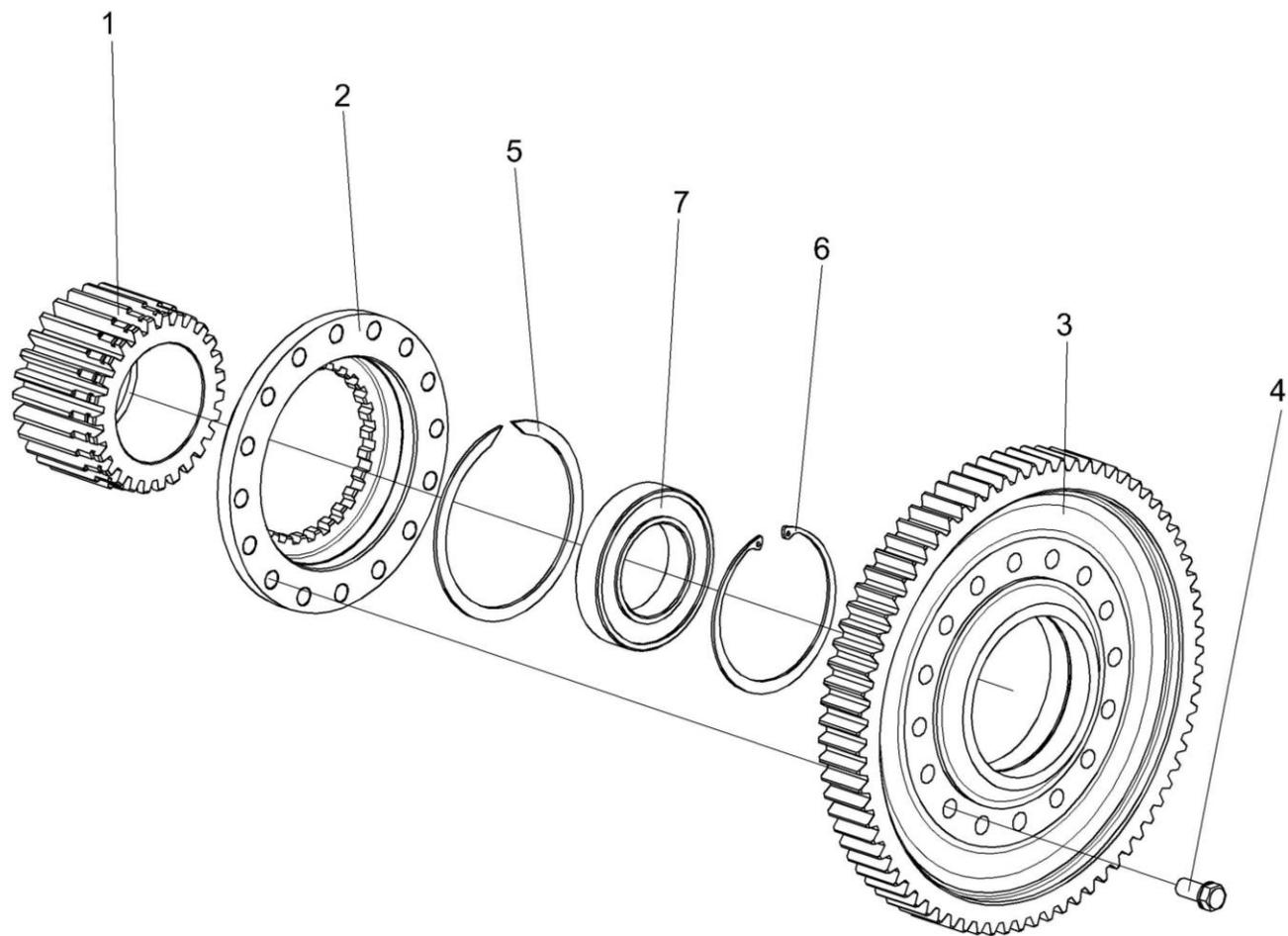
Рисунок 76 – Колесо зубчатое МК-23М.03.210
