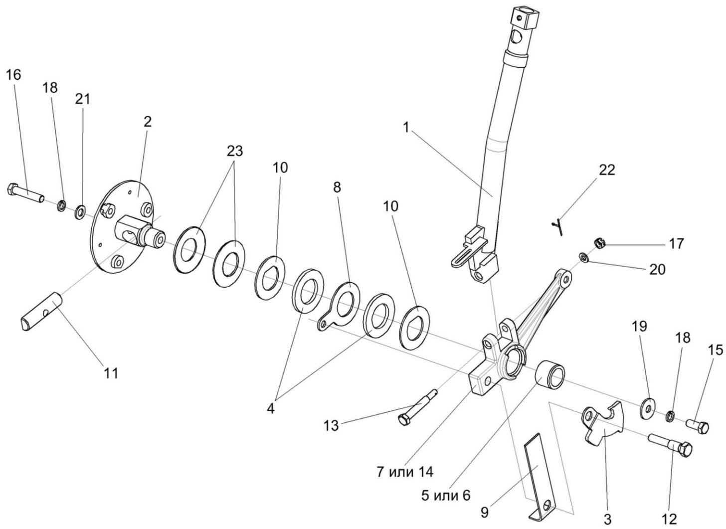
Рисунок 146 – Рычаг КЗК-12-0119920А
