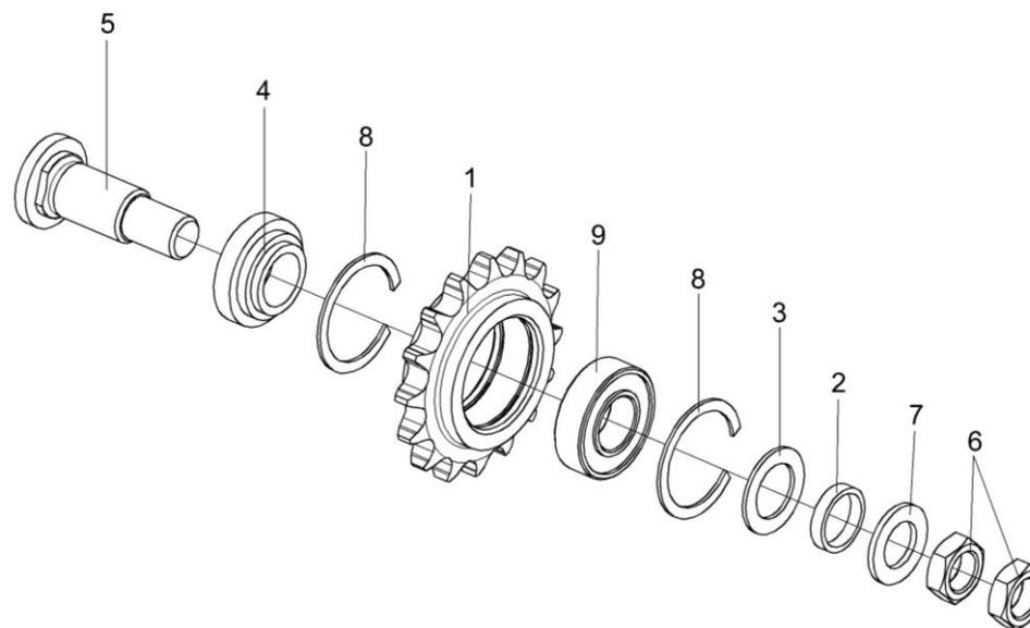
Рисунок 107 – Звездочка КЗР 0219070Б
