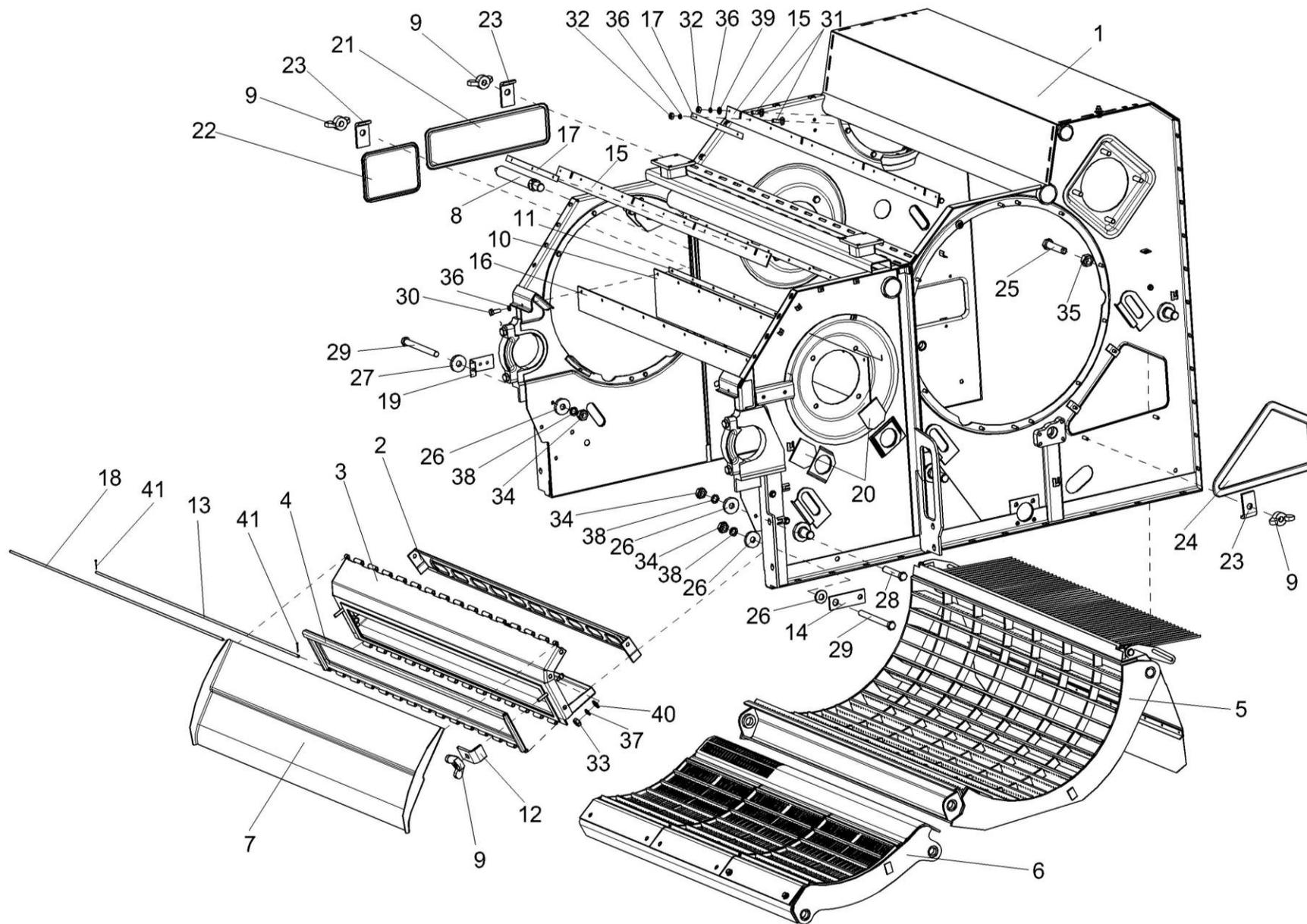
Рисунок 58 – Аппарат молотильный КЗК-12-1-0102000. Камнеуловитель, подбарабанья
