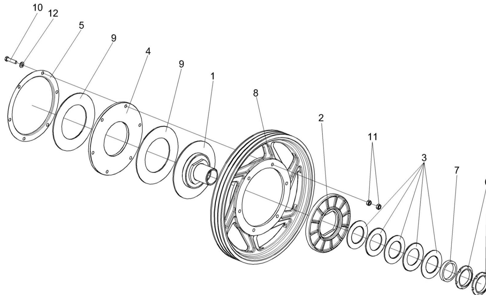
Рисунок 15 – Муфта предохранительная КЗК 1873100
