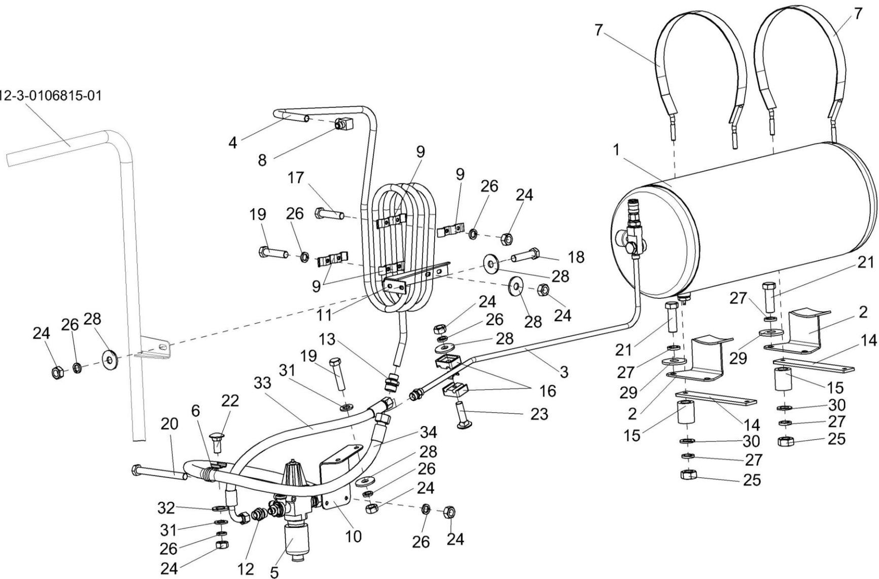
Рисунок 235 – Пневмосистема K3K-12-0800000
