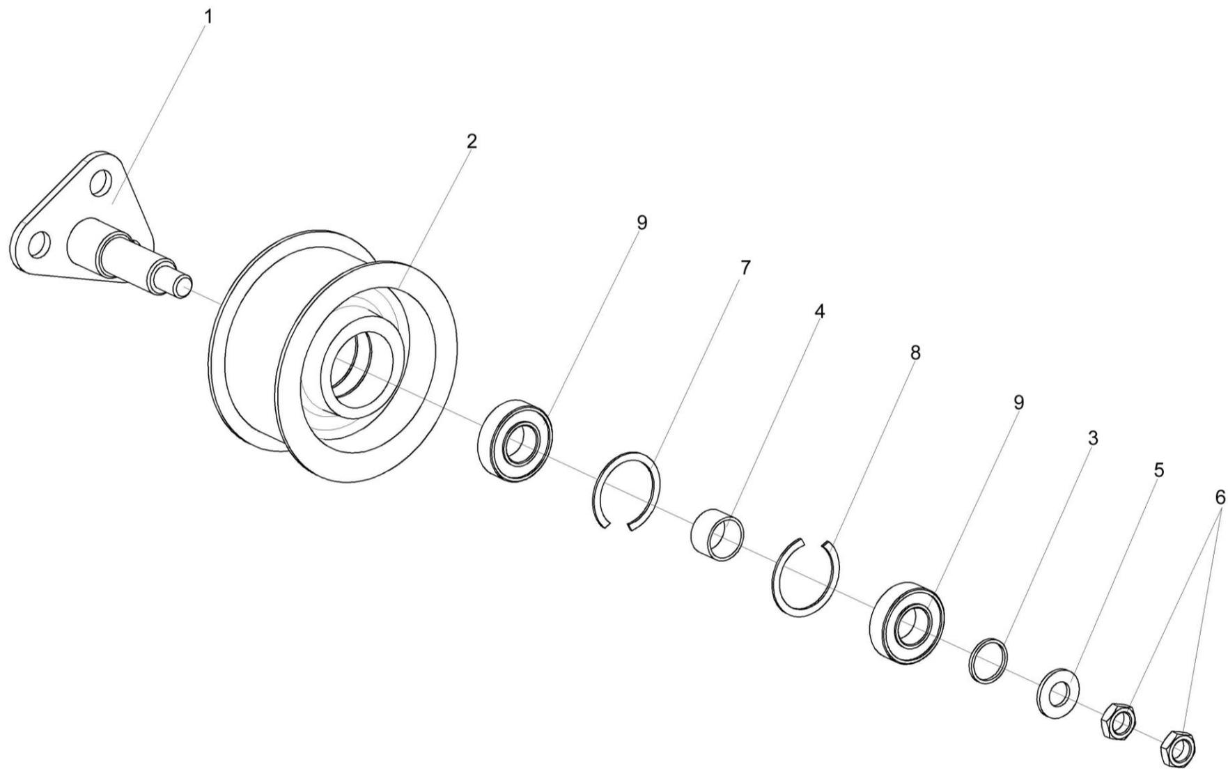
Рисунок 32 – Ролик КЗК-12-0125110А
