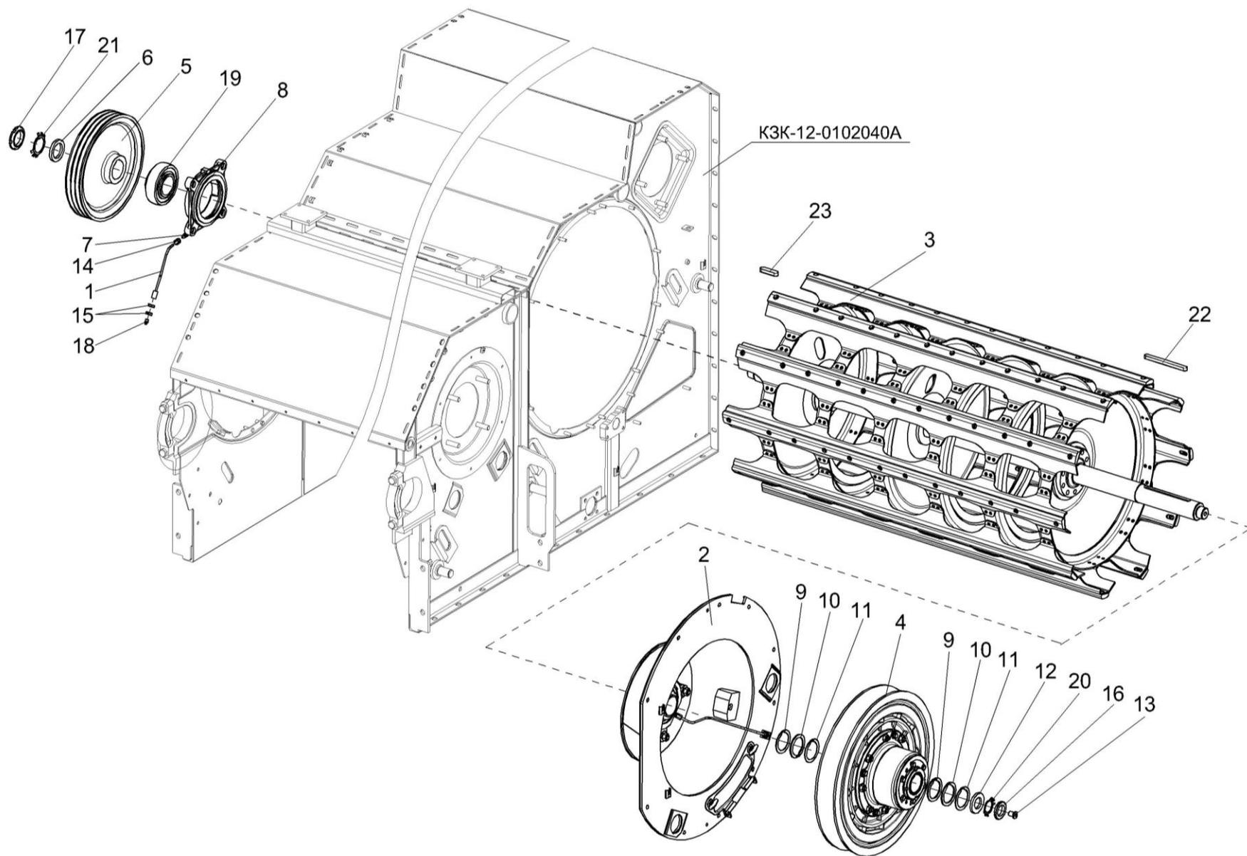
Рисунок 55 – Аппарат молотильный КЗК-12-1-0102000 (установка барабана молотильного)
