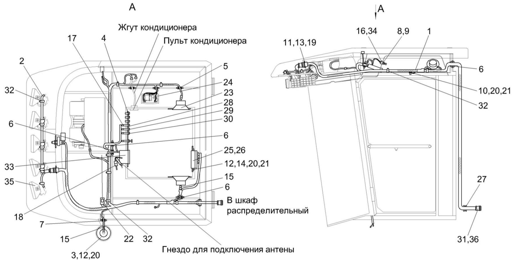
Рисунок 135 – Электрооборудование кабины КЗК-12-0120000
