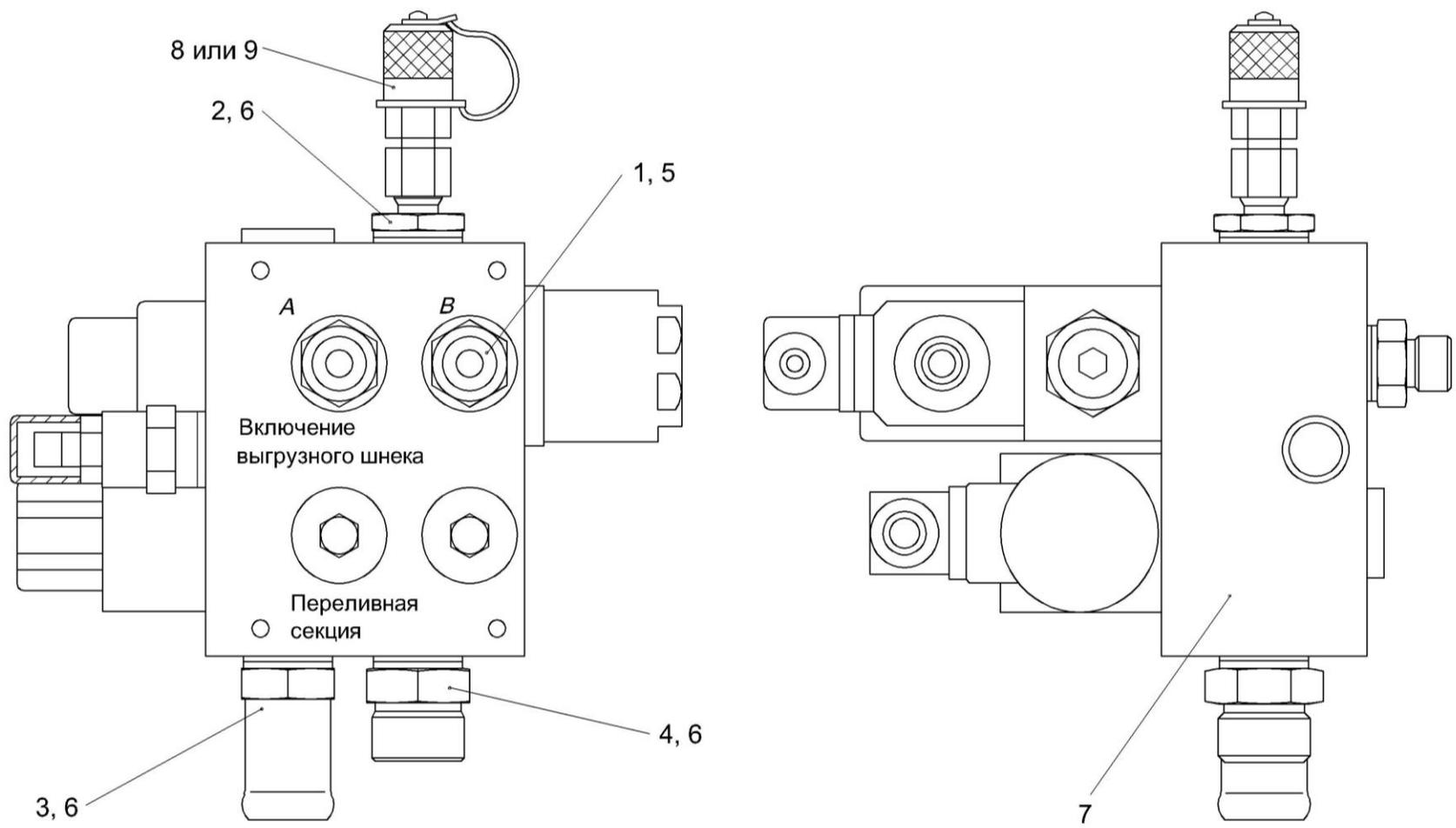
Рисунок 229 – Гидроблок двухсекционный КЗК-12-0602660
