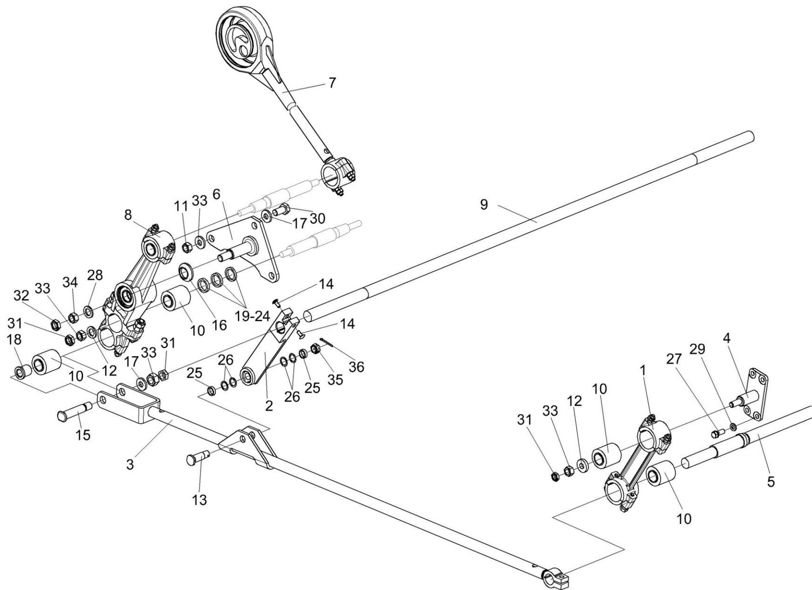
Рисунок 43 – Установка привода доски стрясной КЗК-12-0280000А (вид справа)
