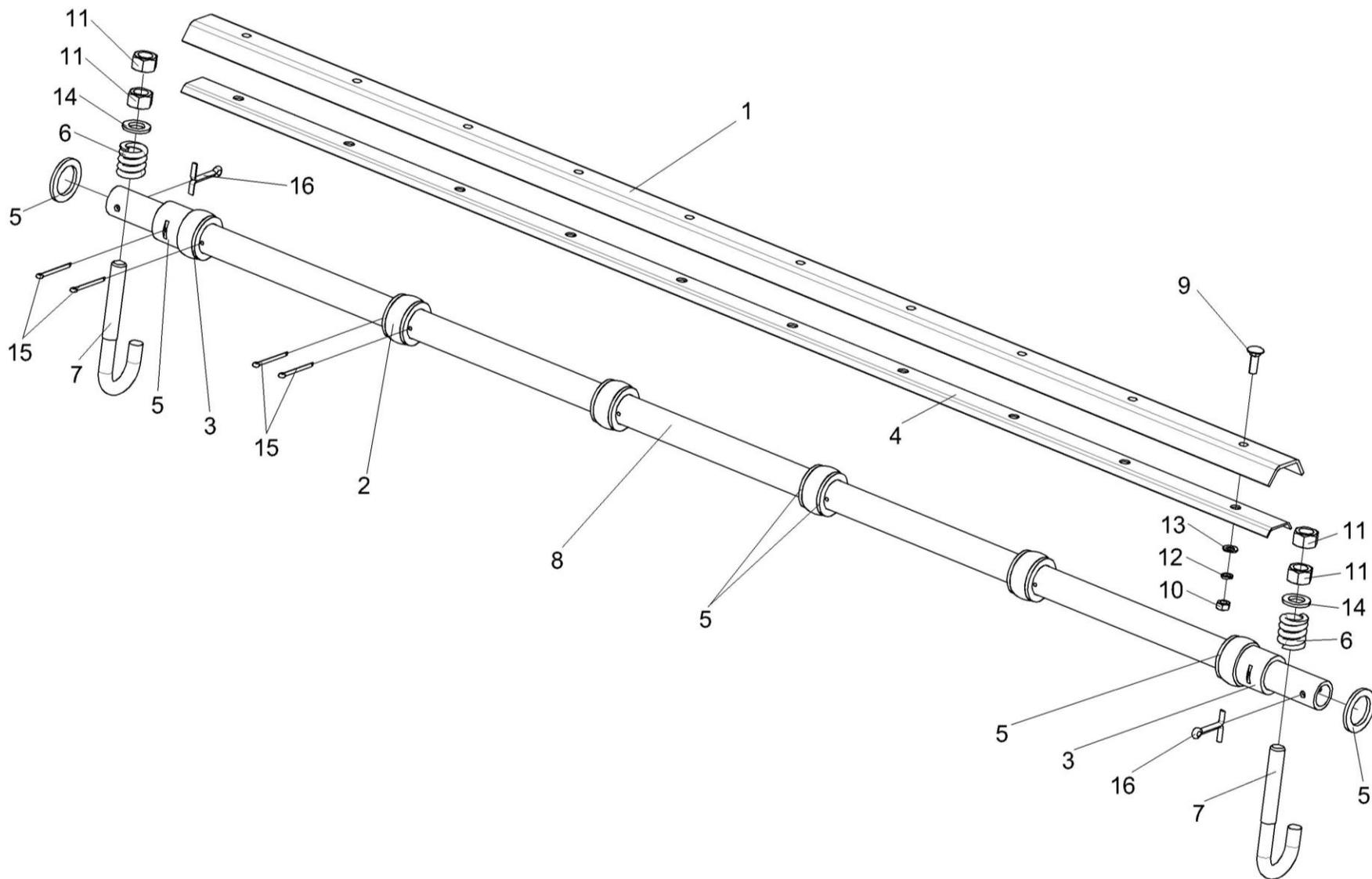
Рисунок 22 – Камера наклонная. Установка трубы КЗК 1770010-01
