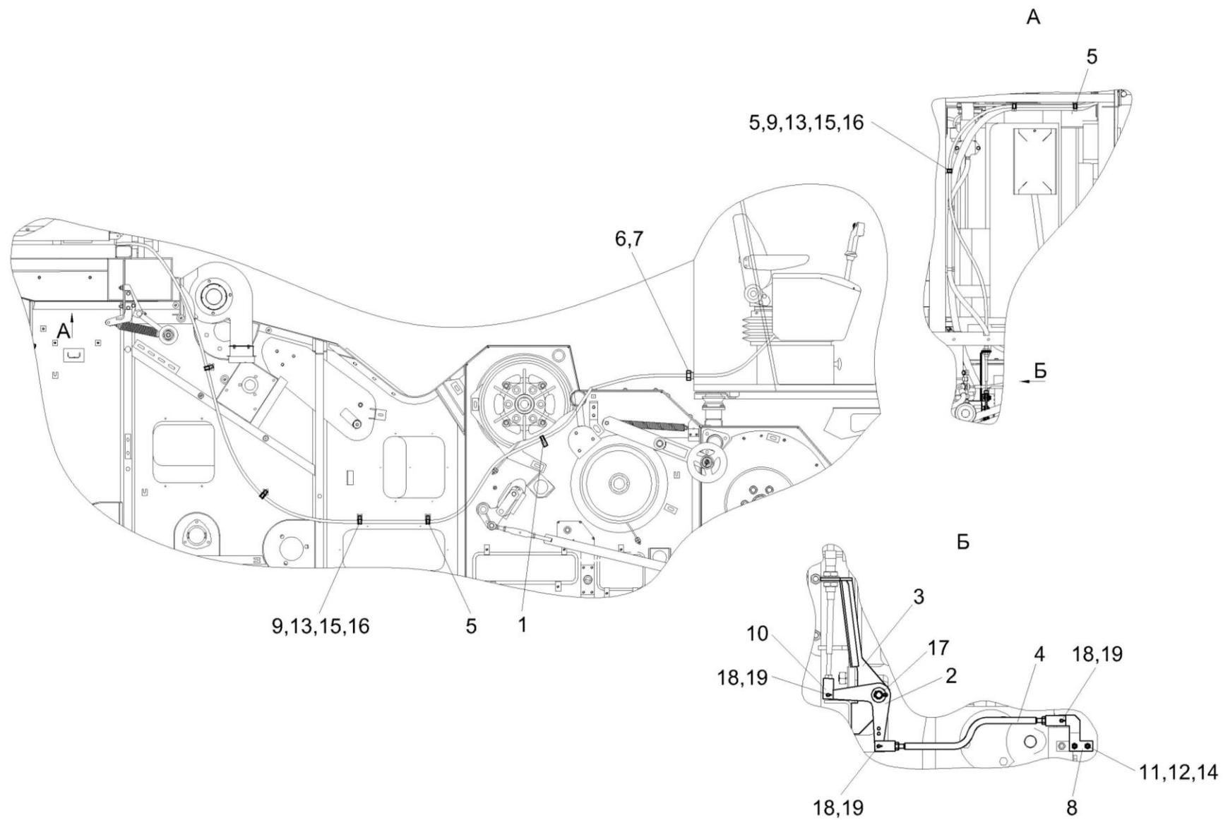
Рисунок 164 – Установка троса управления гидронасосом хода КЗК-12-0119620Б
