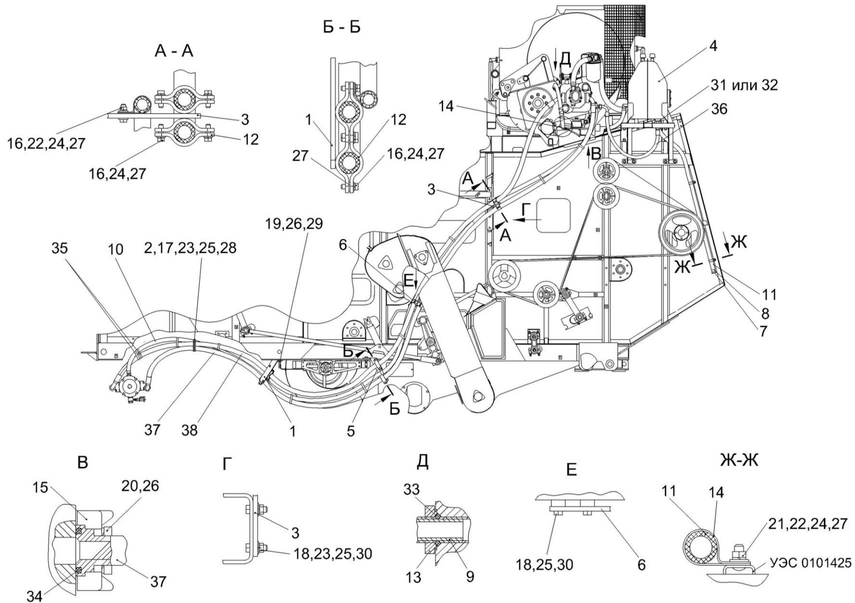
Рисунок 211 – Гидросистема привода ходовой части КЗК-12-0601000Б (вид слева)
