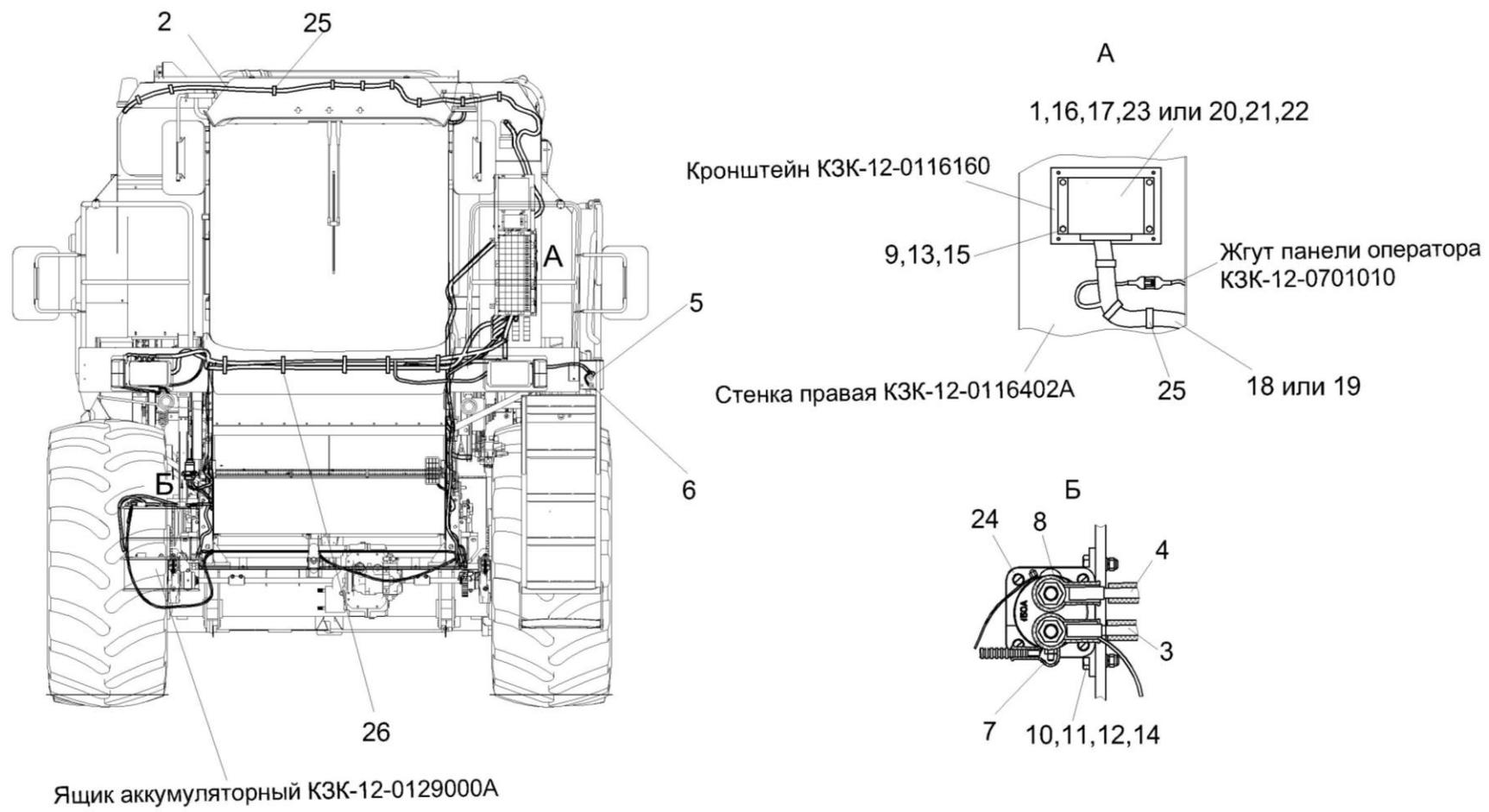
Рисунок 9 – Электрооборудование молотилки самоходной КЗК-12-0100000Б-12 (лист 4)
