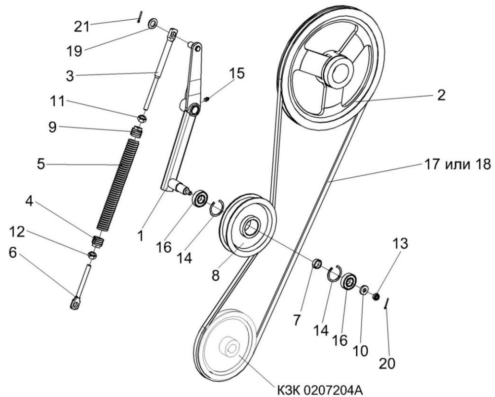
Рисунок 52 – Установка привода устройства домолачивающего
