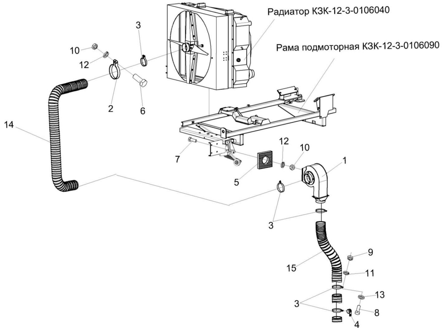
Рисунок 204 – Установка вентилятора КЗК-12-3-0112240
