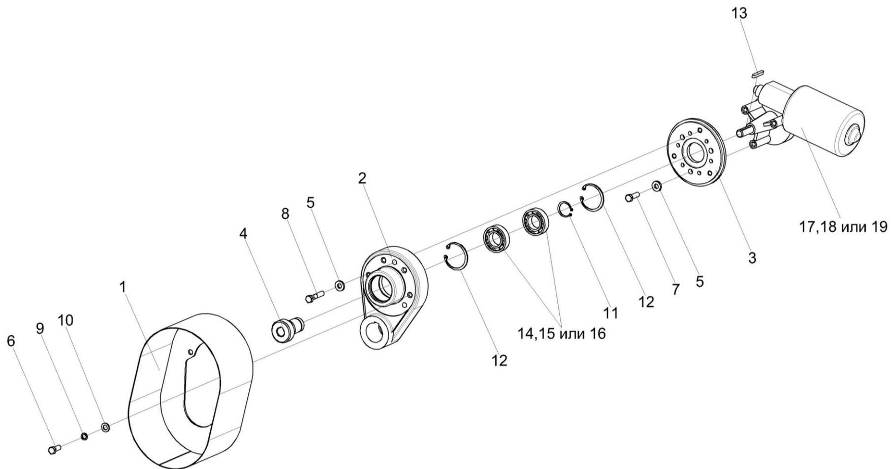
Рисунок 50 – Привод КЗК-12-0202690А
