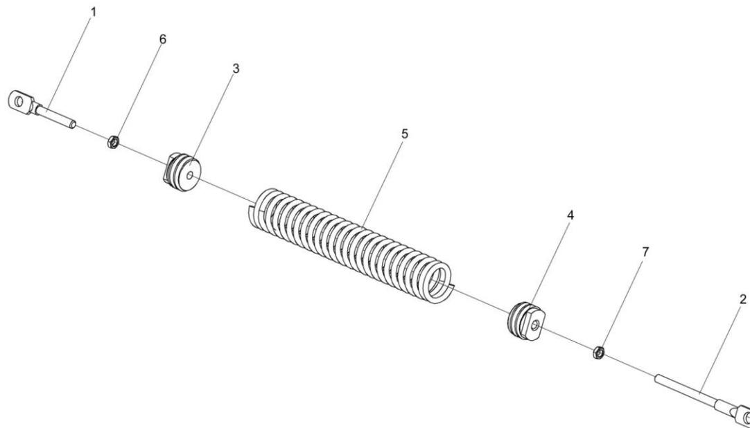
Рисунок 31 – Пружина КЗК-12-0125050
