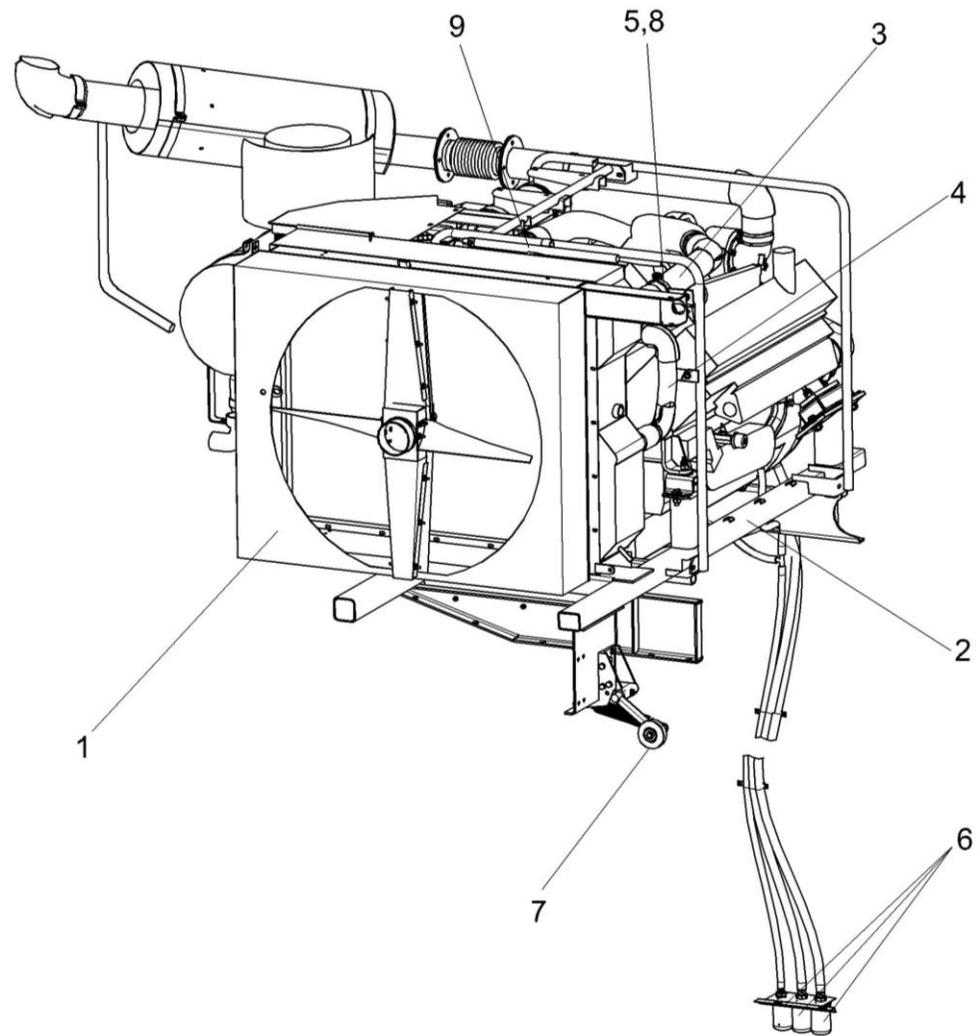
Рисунок 183 – Установка двигателя КЗК-12-3-0106000-01 (лист 2)
