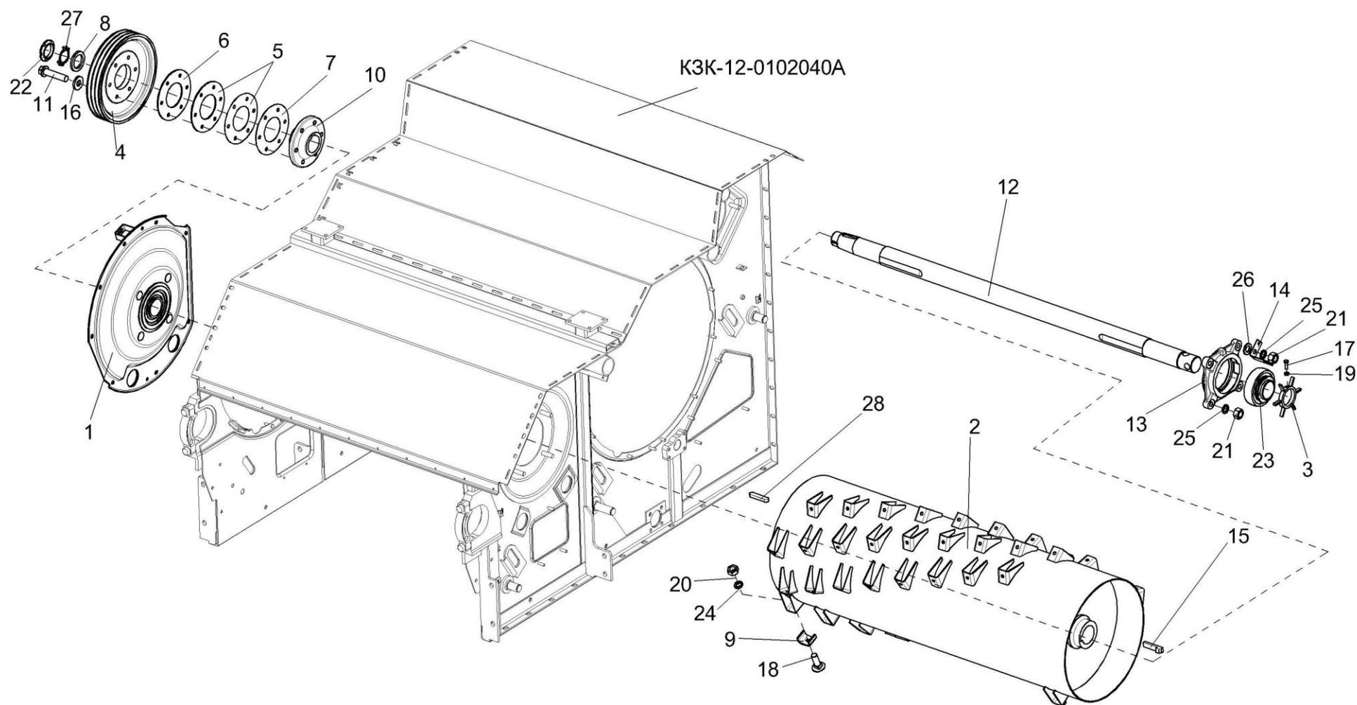
Рисунок 56 – Аппарат молотильный КЗК-12-1-0102000 (установка барабана ускоряющего)
