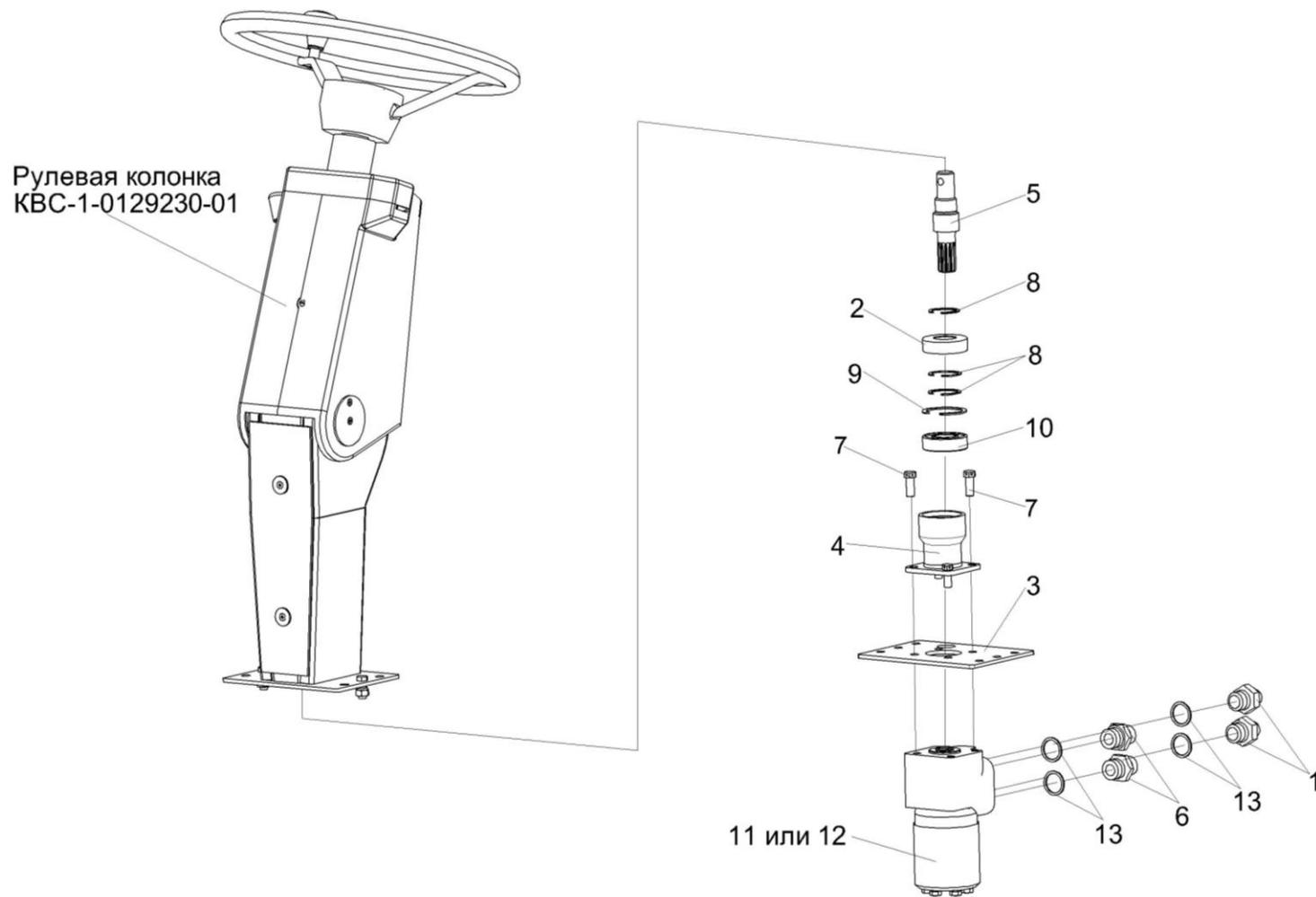
Рисунок 155 – Установка насоса-дозатора КЗК-10-0602090
