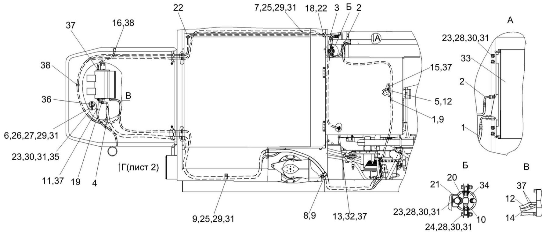
Рисунок 136 – Установка климатическая КЗК-12-0113000Б-01 (лист 1)
