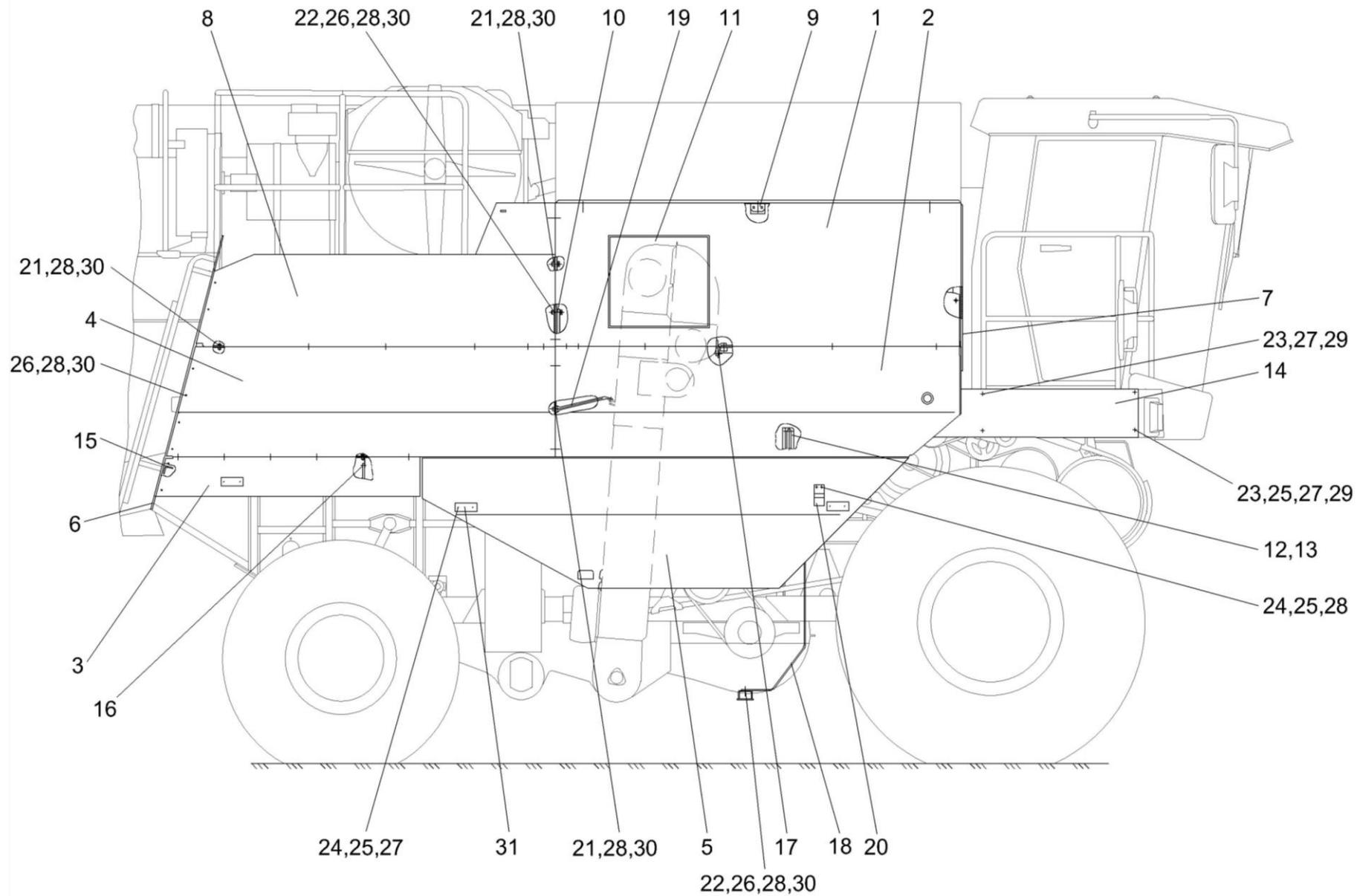
Рисунок 171 – Установка капотов и ограждения КЗК-12-0128000А (вид справа)
