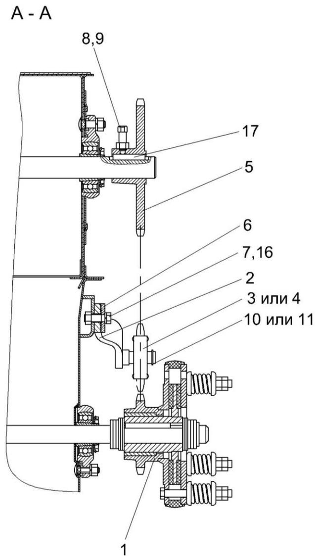
Рисунок 37 – Установка цепного привода элеватора колосового
