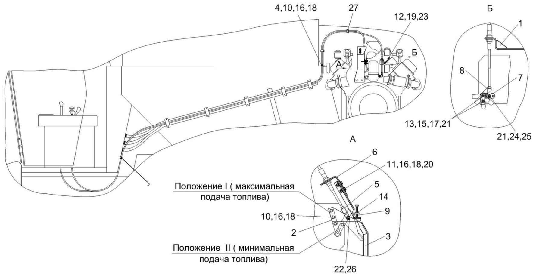
Рисунок 166 – Установка тросов управления двигателем КЗК-12-0119640Б
