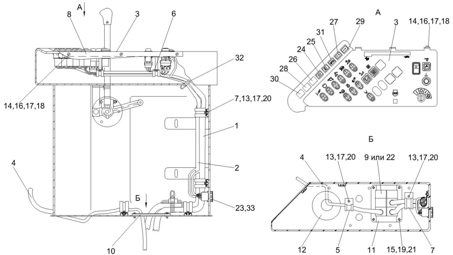
Рисунок 151 – Электрооборудование пульта управления КЗК-12-0119500А-01
