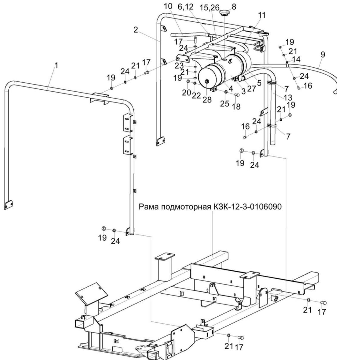
Рисунок 197 – Установка бачка расширительного КЗК-12-3-0106070
