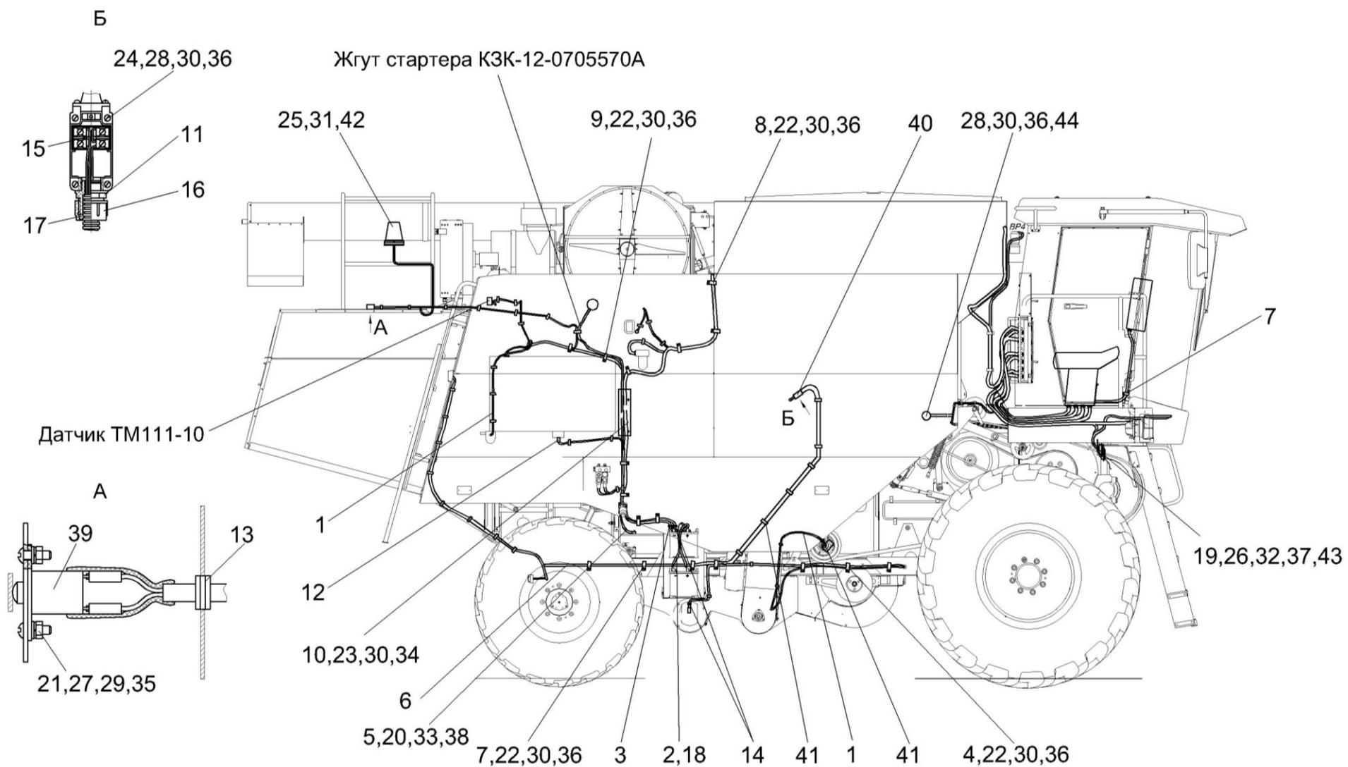
Рисунок 7 – Электрооборудование молотилки самоходной КЗК-12-010000Б-12 (лист 2)
