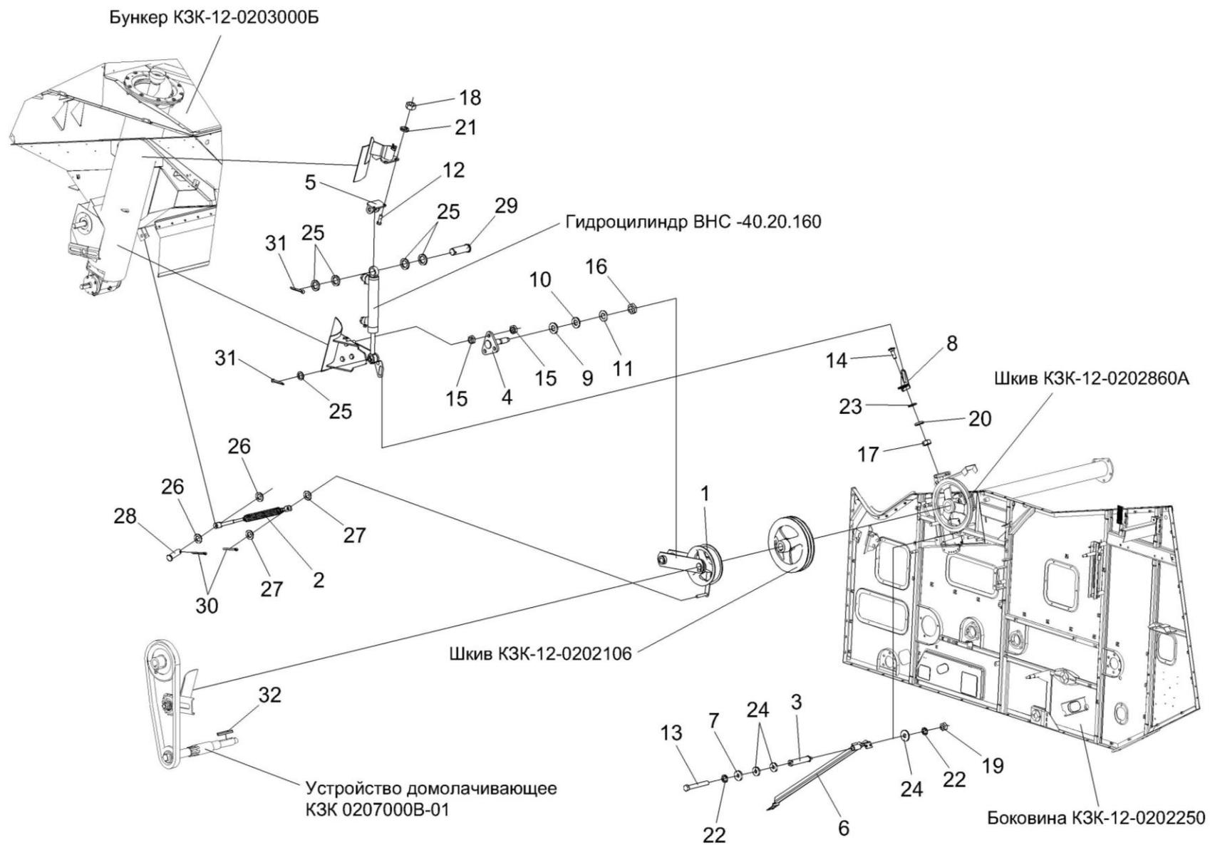
Рисунок 118 – Привод выгрузки КЗК-12-0221100 (лист 1)
