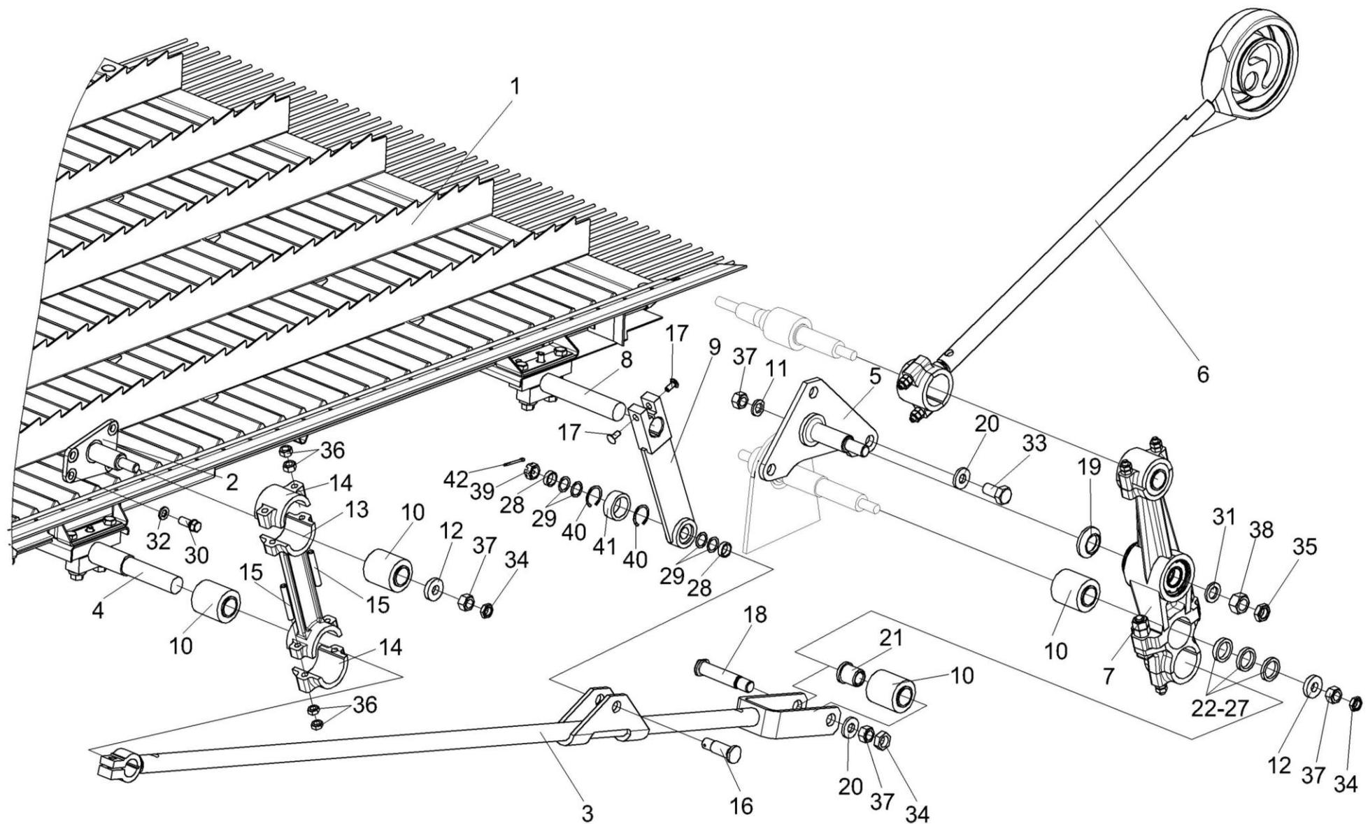
Рисунок 42 – Установка привода доски стрясной КЗК-12-0280000А (вид слева)
