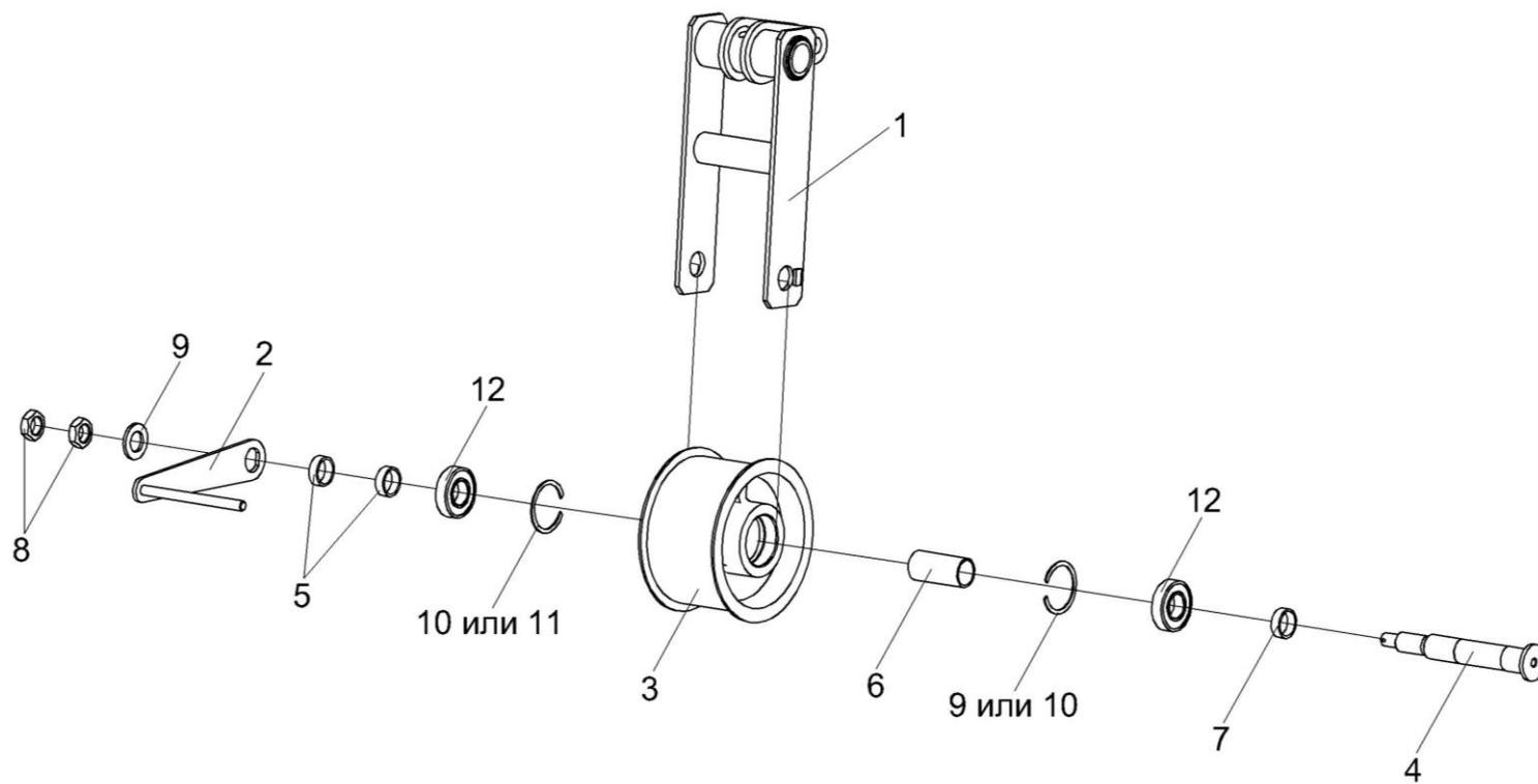
Рисунок 208 – Рычаг КЗК-12-3-0220110А
