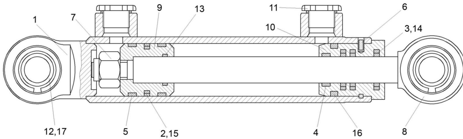
Рисунок 26 – Гидроцилиндр КИЛ 0118760
