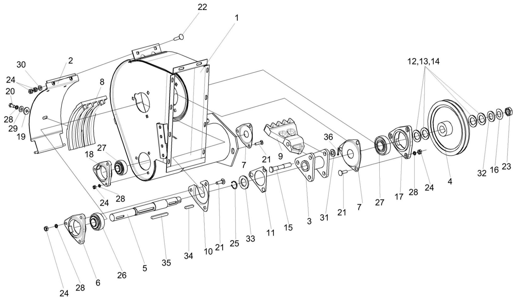
Рисунок 53 – Устройство домолачивающее КЗК 0207000В-01
