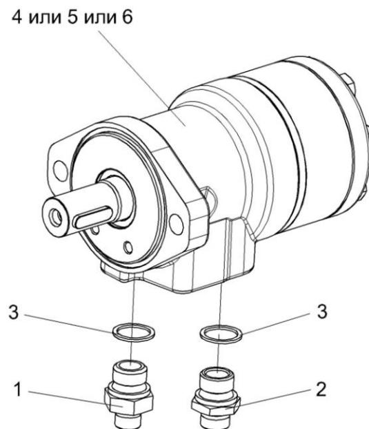
Рисунок 20 – Гидромотор КЗК-12-1790990А
