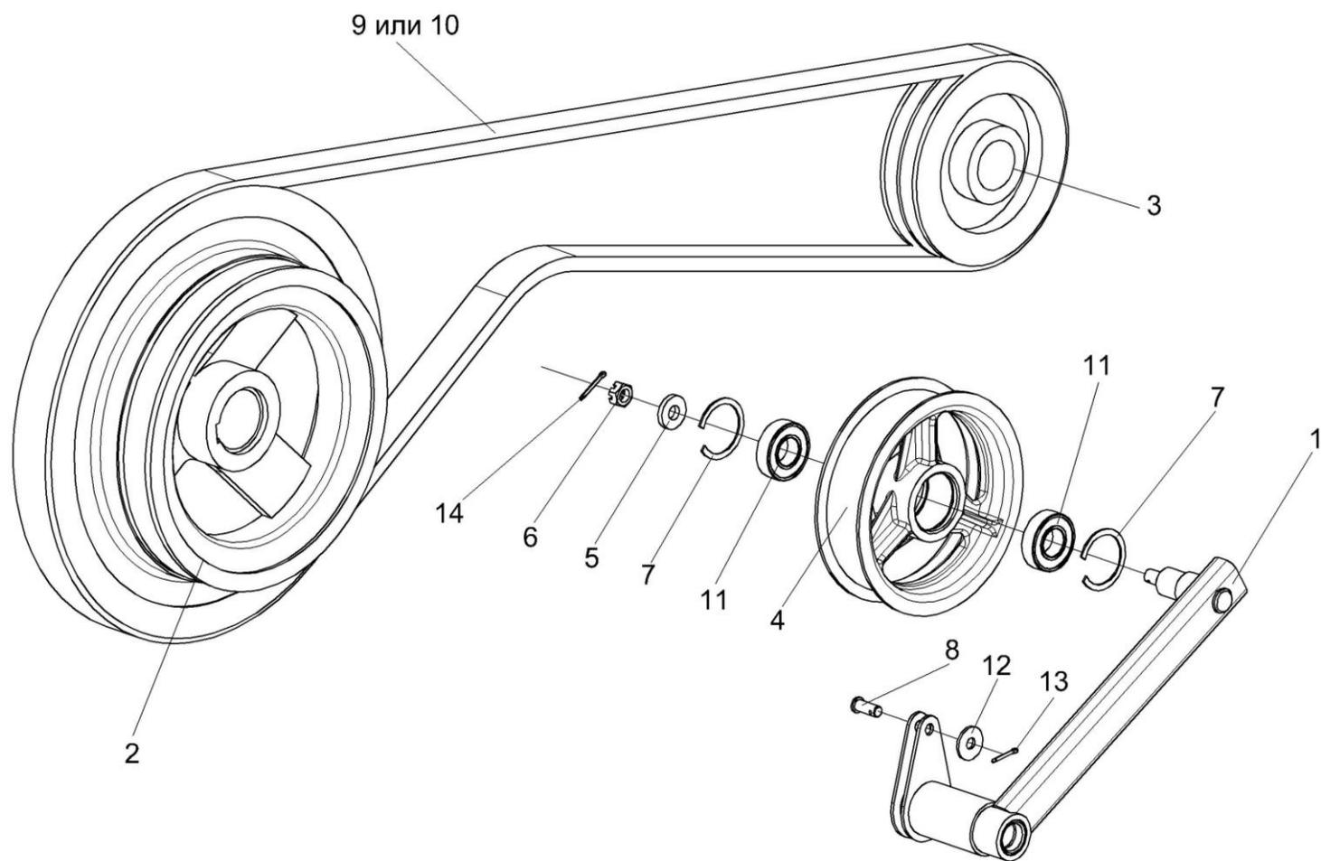
Рисунок 51 – Установка рычага КЗК 0202430Б
