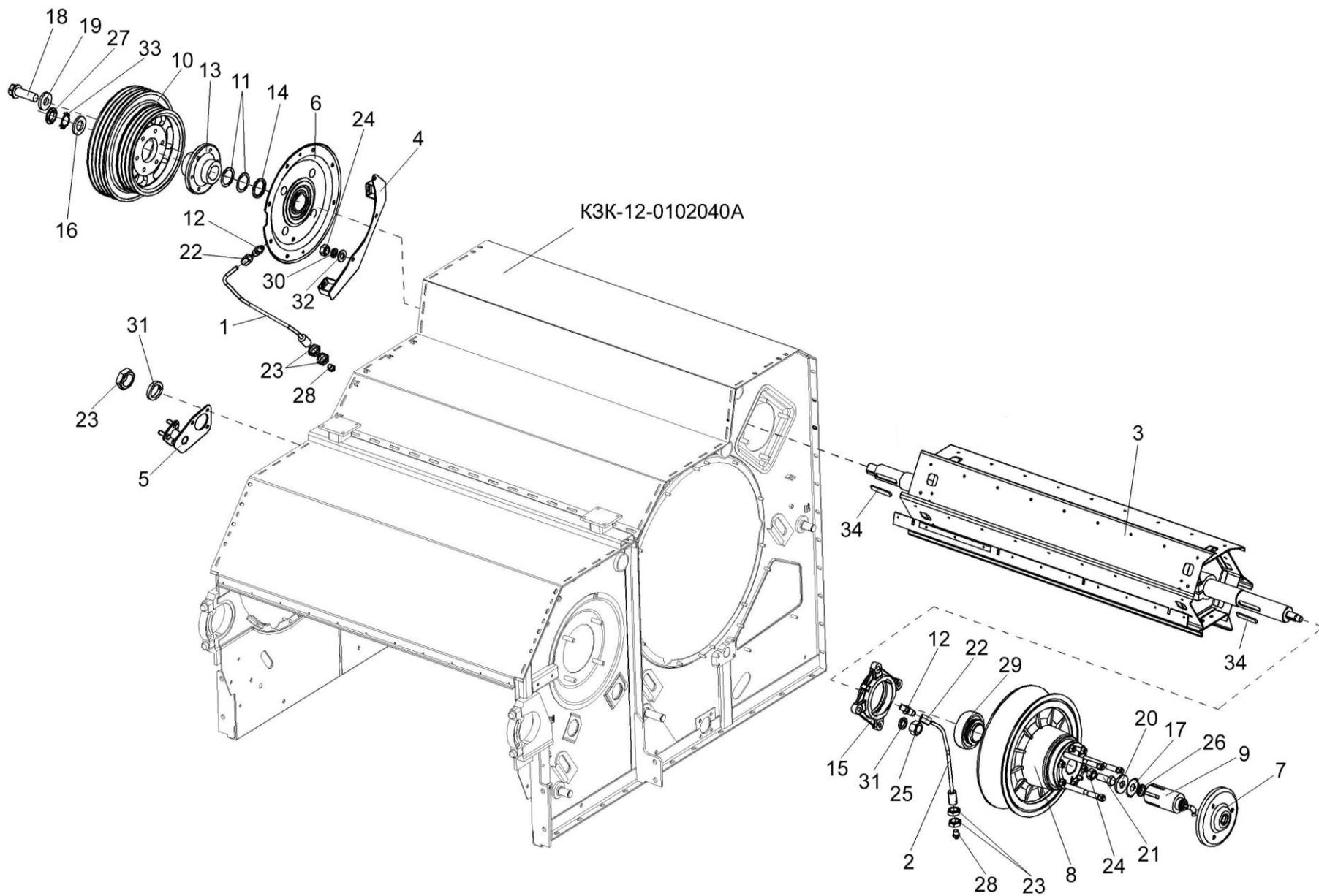
Рисунок 54 – Аппарат молотильный КЗК-12-1-0102000 (установка битера отбойного)
