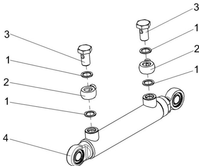
Рисунок 231 – Гидроцилиндр КЗК-12-0602730
