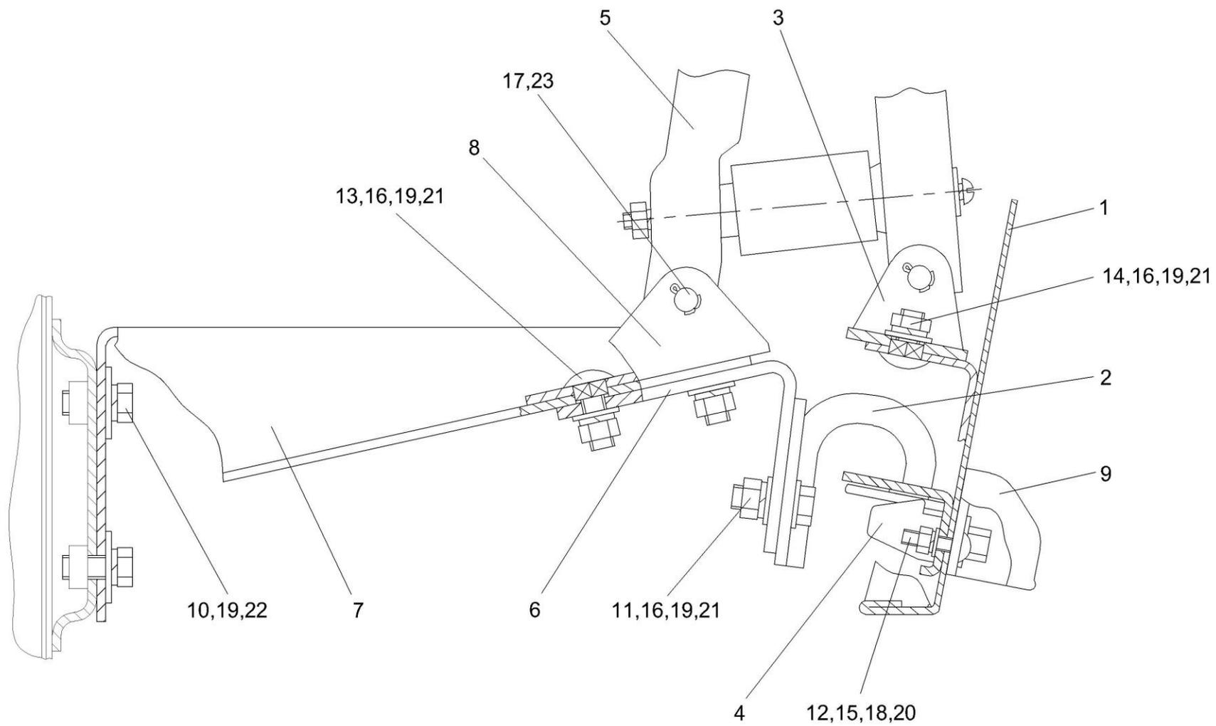
Рисунок 173 – Установка капота КЗК-12-0128110-01
