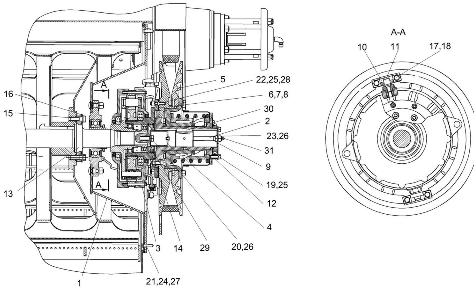
Рисунок 238 – Установка редуктора КЗК-12-0102700
