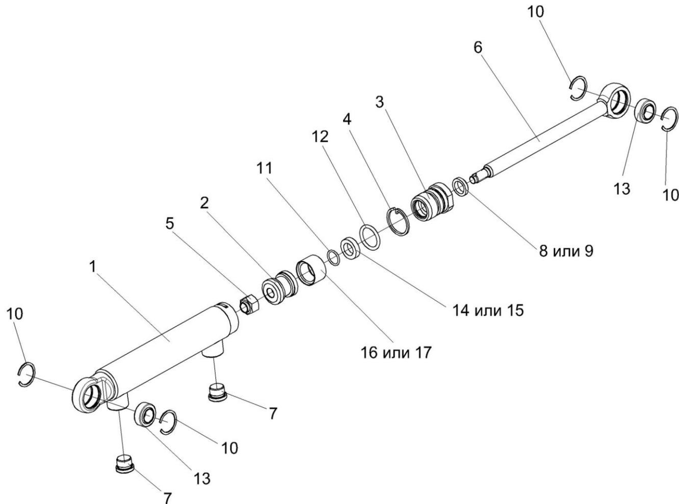
Рисунок 25 – Гидроцилиндр КИЛ 0118380А
