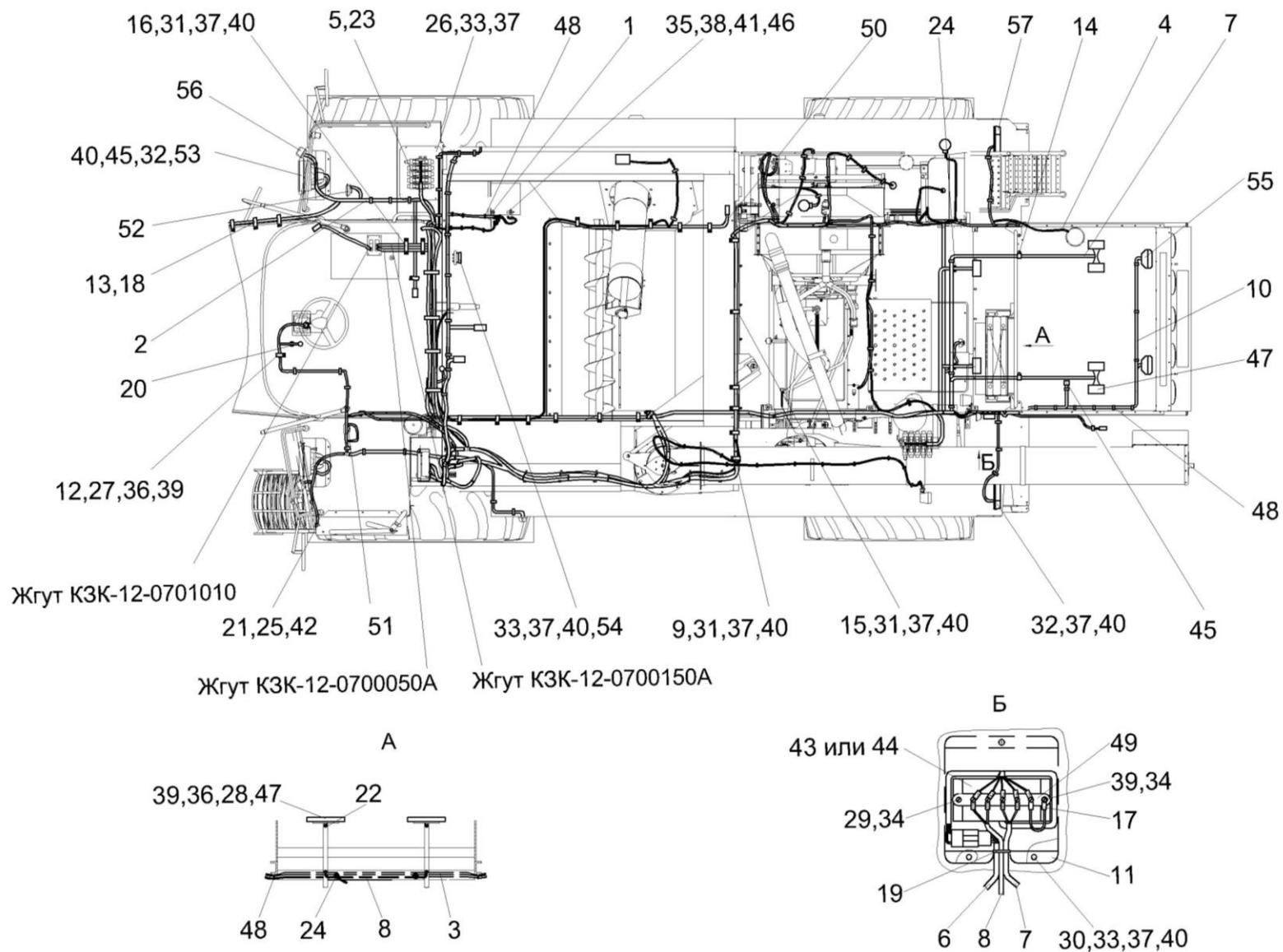
Рисунок 8 – Электрооборудование молотилки самоходной КЗК-12-010000Б-12 (лист 3)
