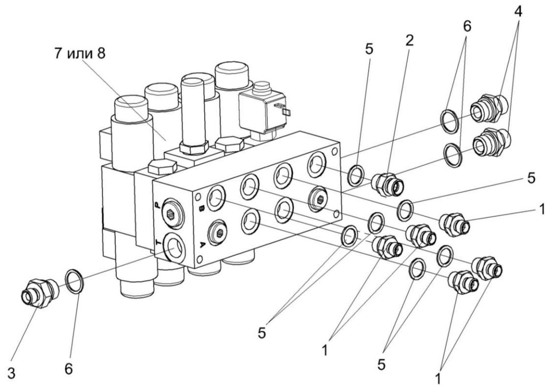
Рисунок 228 – Гидроблок четырехсекционный КЗК-12-0602650
