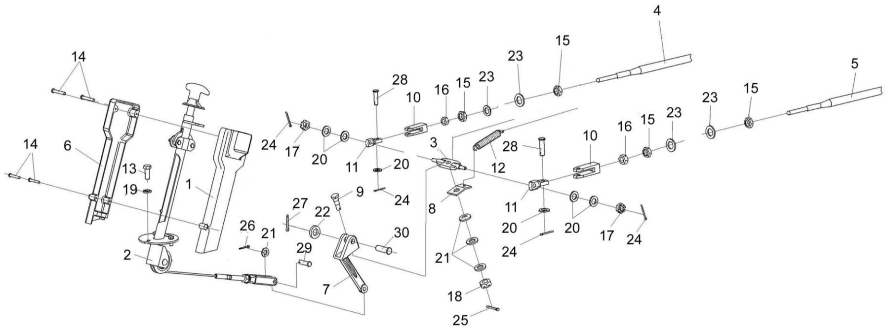
Рисунок 159 – Установка колонки привода УЭС 0300710
