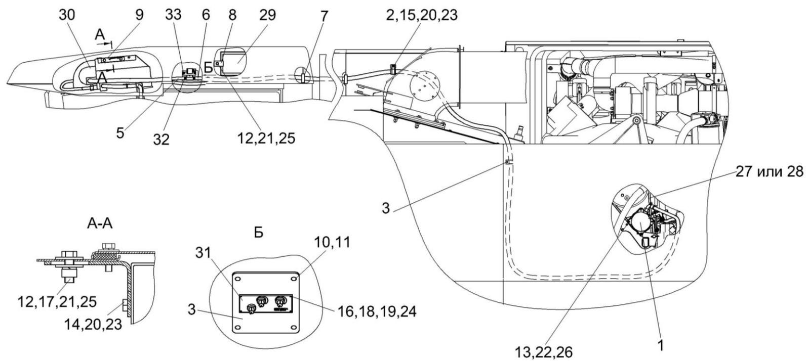
Рисунок 137 – Установка климатическая КЗК-12-0113000Б-01 (лист 2)
