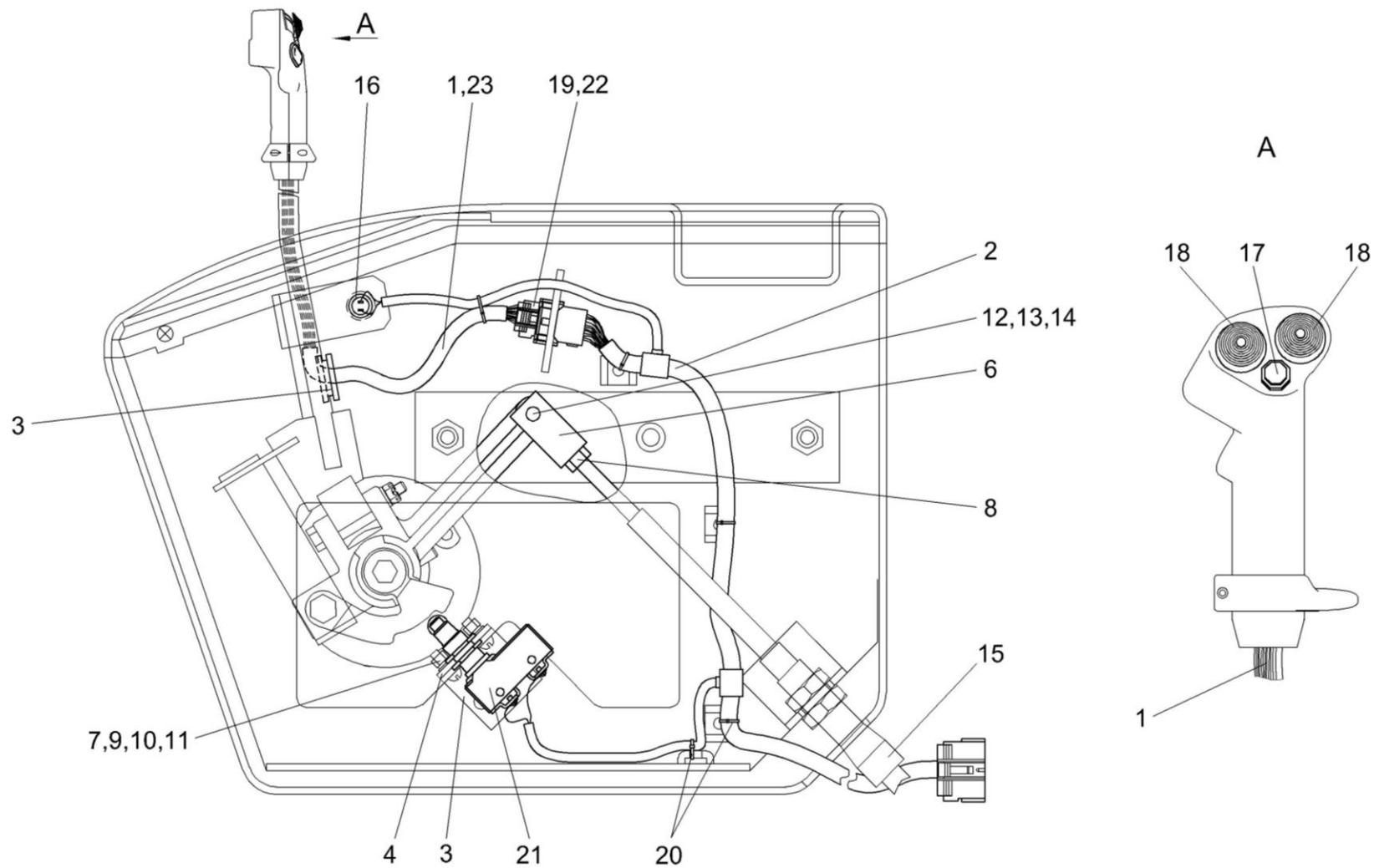
Рисунок 147 – Электрооборудование блока управления КЗК-12-0119890А-01
