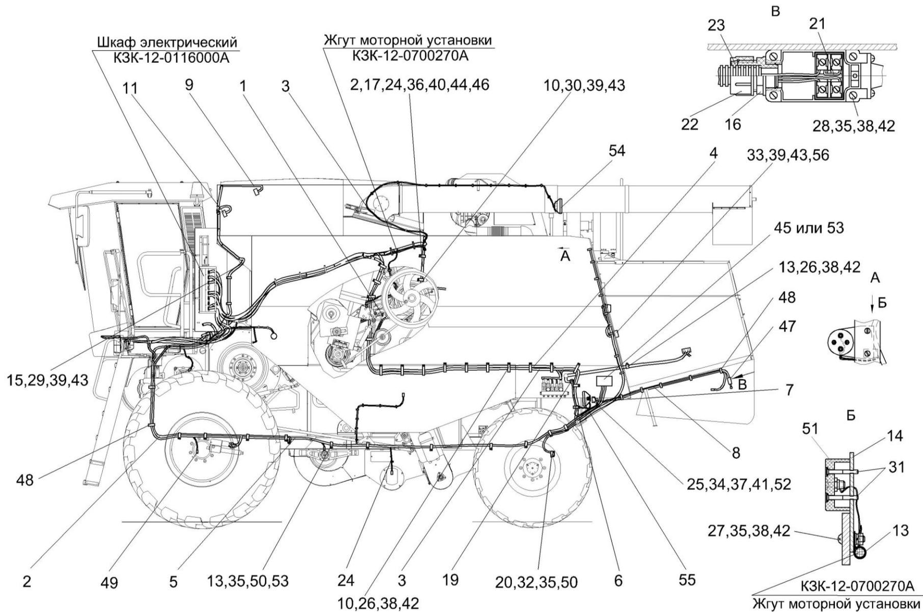
Рисунок 6 – Электрооборудование молотилки самоходной КЗК-12-010000Б-12 (лист 1)
