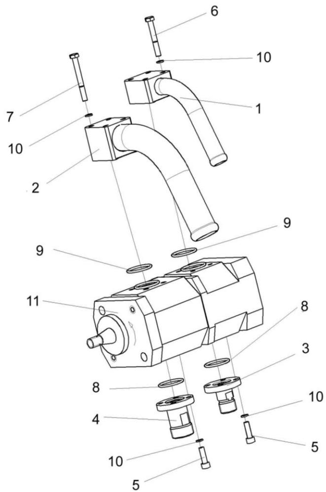
Рисунок 192 – Гидронасос двухсекционный КЗК-12-0602910
