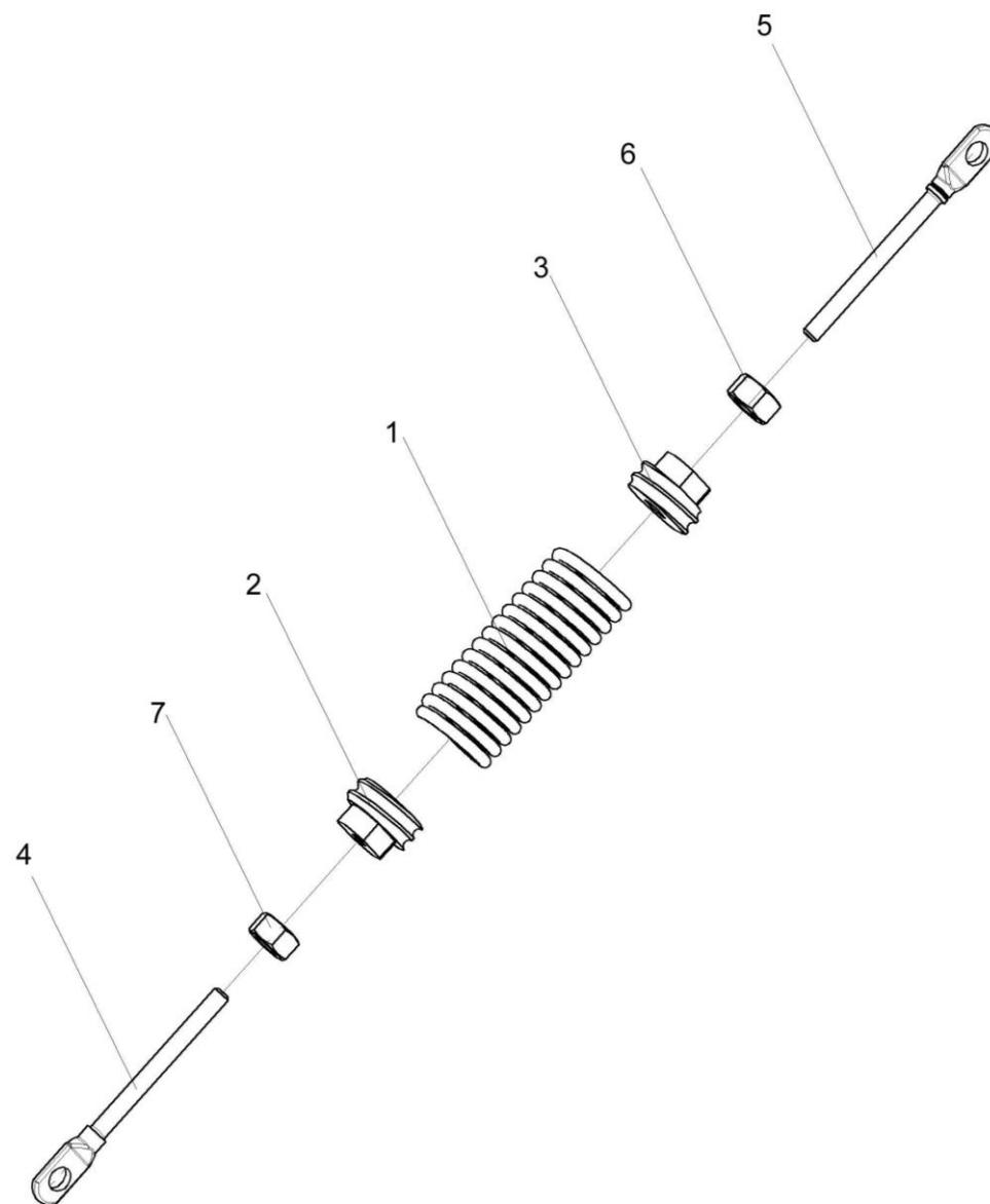
Рисунок 207 – Пружина КЗК-12-3-0220050
