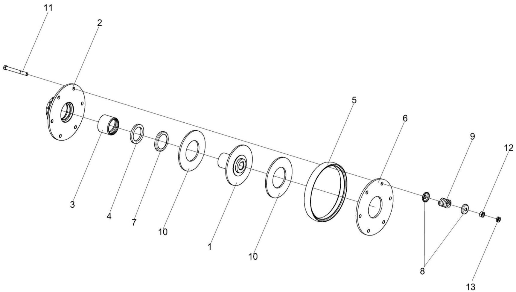
Рисунок 38 – Муфта фрикционная КЗК 0219020Б-01
