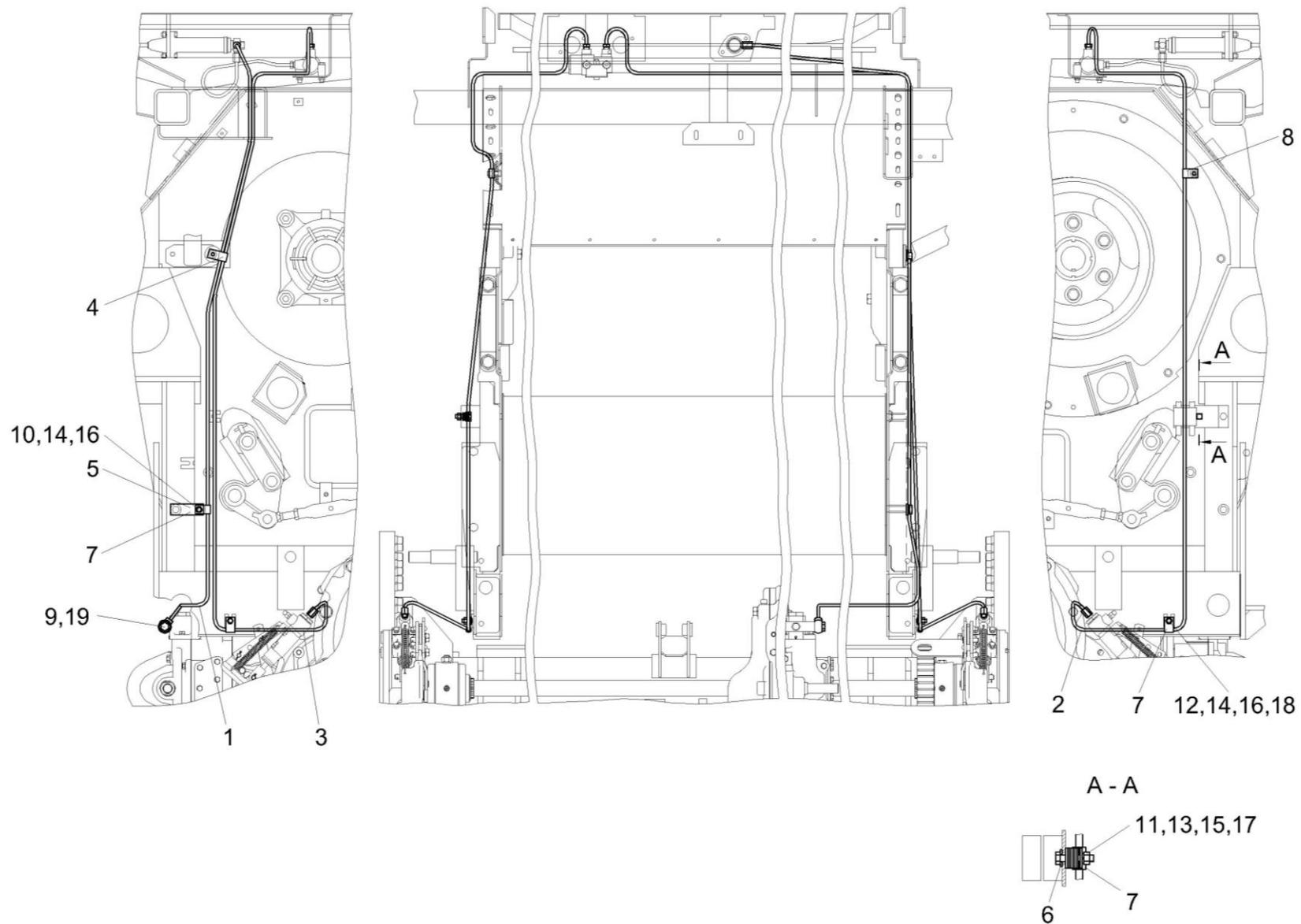
Рисунок 165 – Установка трубопроводов моста ведущих колес КЗК-12-0119630
