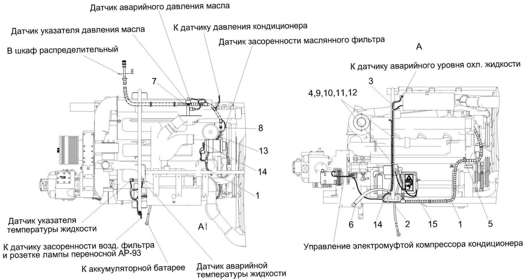
Рисунок 210 – Электрооборудование установки двигателя КЗК-12-3-0106000-01
