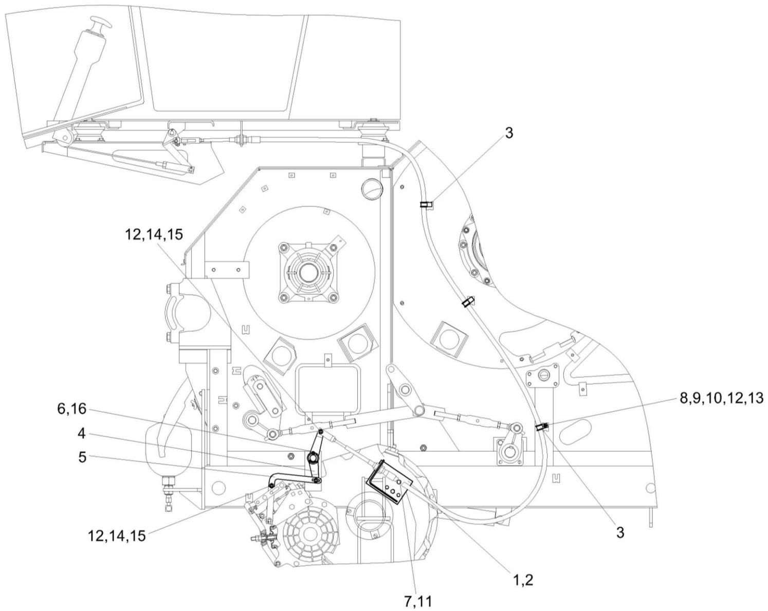
Рисунок 163 – Установка тросов управления стояночным тормозом КЗК-12-0119610
