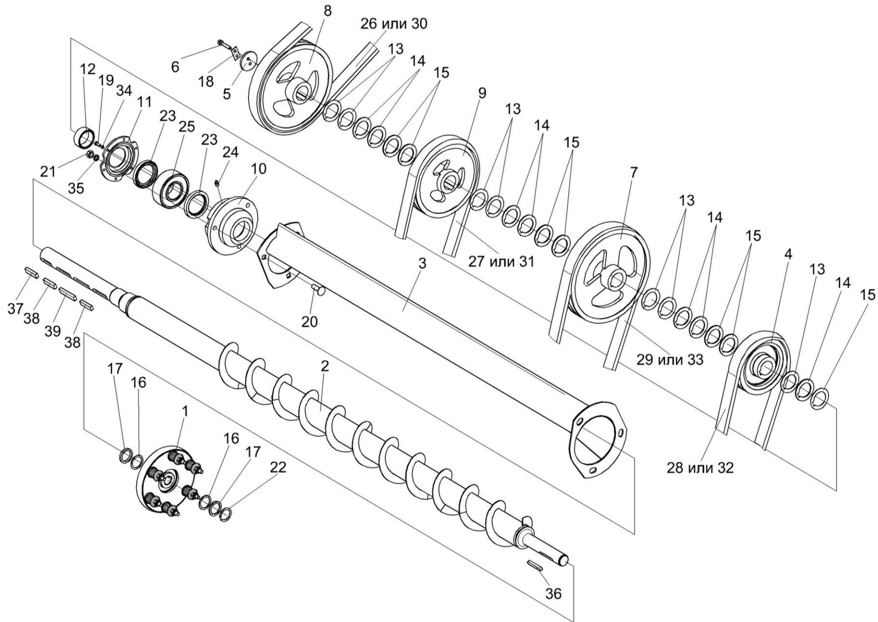
Рисунок 36 – Установка шкивов на шнек КЗК-10-0202770
