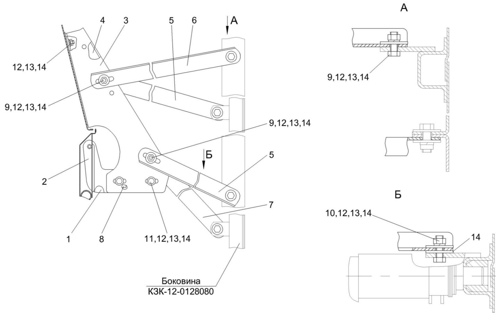
Рисунок 177 – Установка кронштейна КЗК 0128420-01
