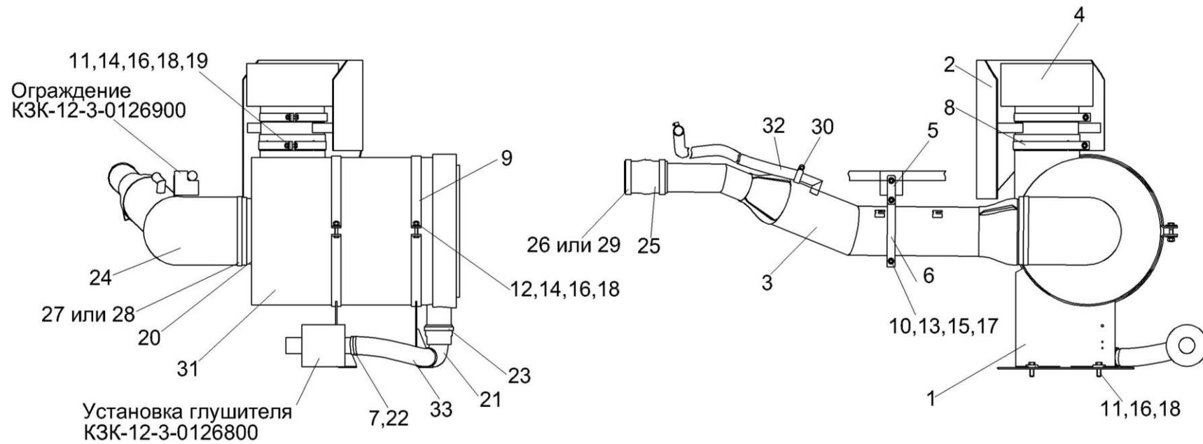
Рисунок 203 – Установка воздухоочистителя K3K-12-3-0126960
