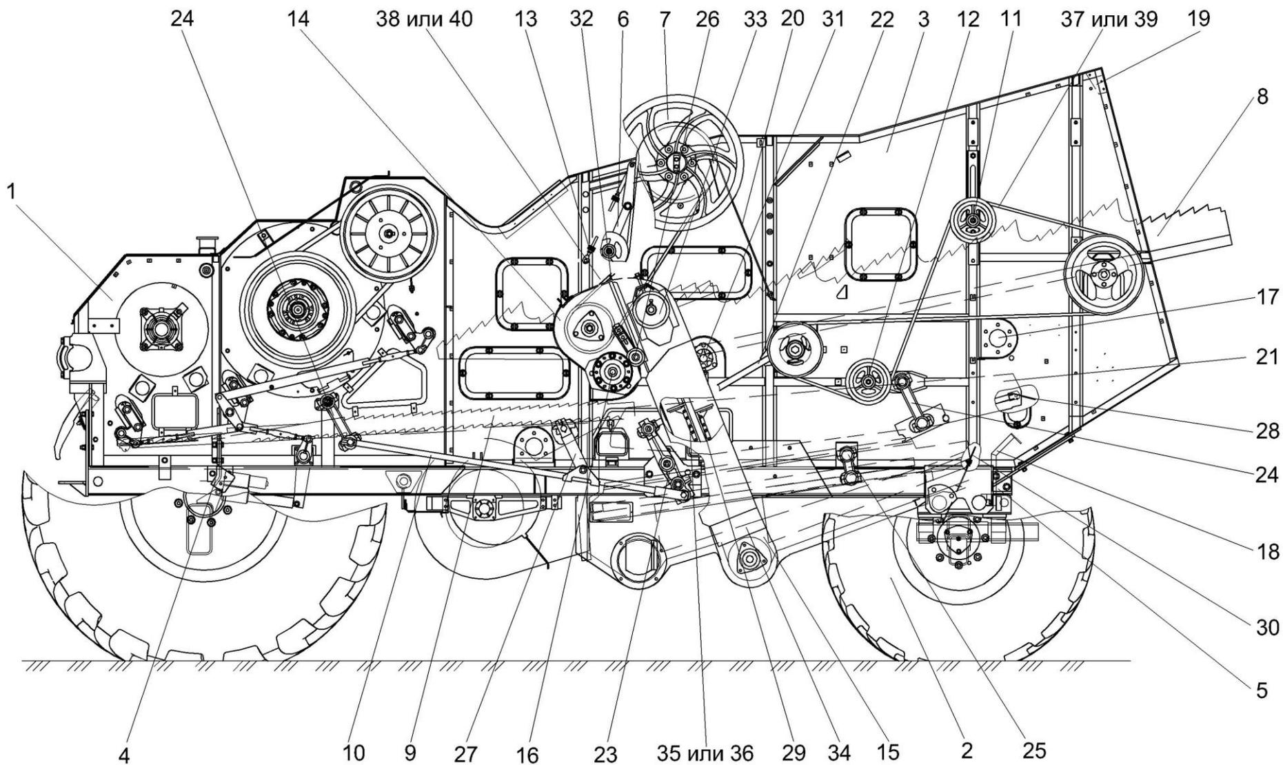
Рисунок 33 – Очистка КЗК-12-0202000Б-03 (вид слева)
