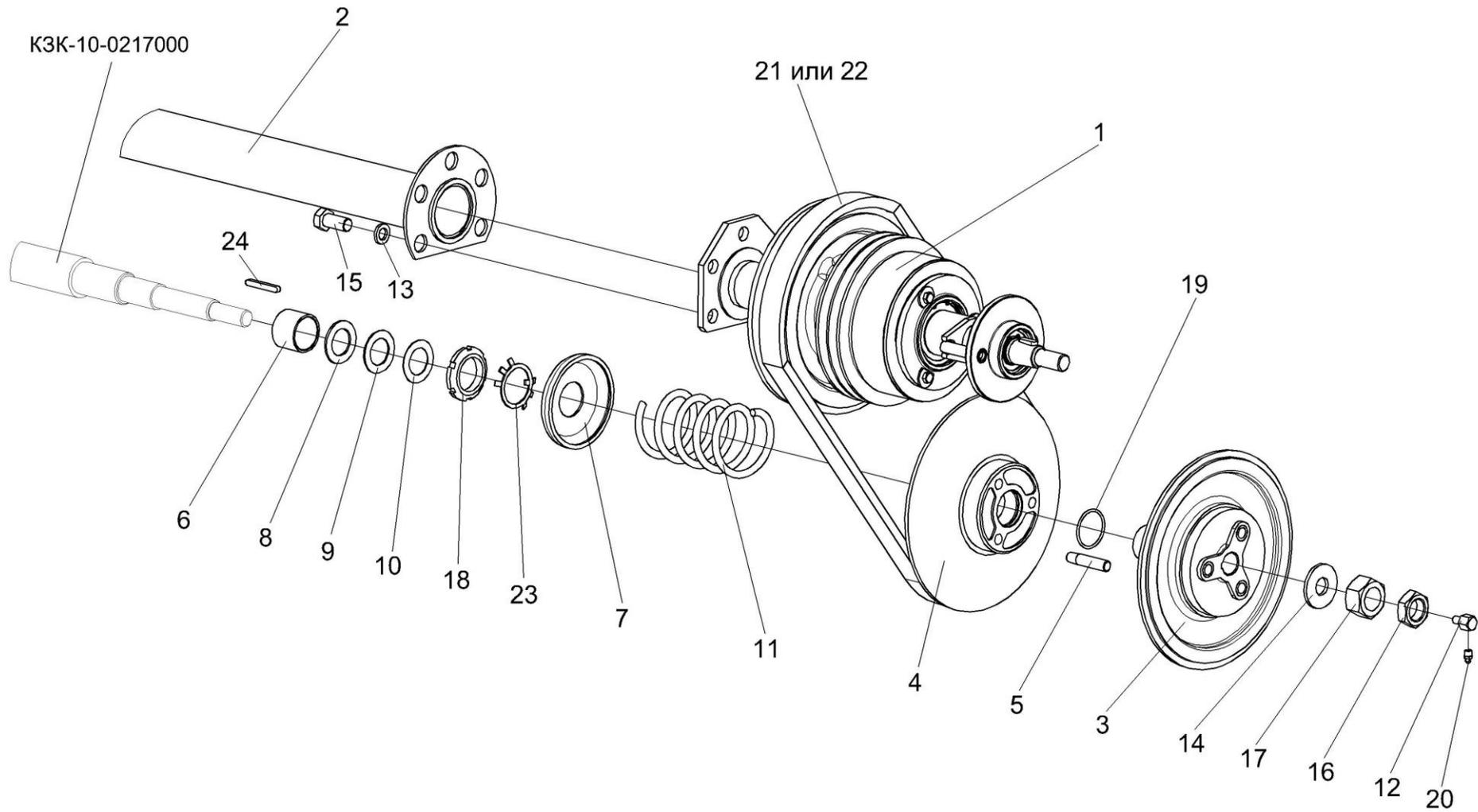
Рисунок 48 – Установка контрпривода вариатора K3K-12-0202500A
