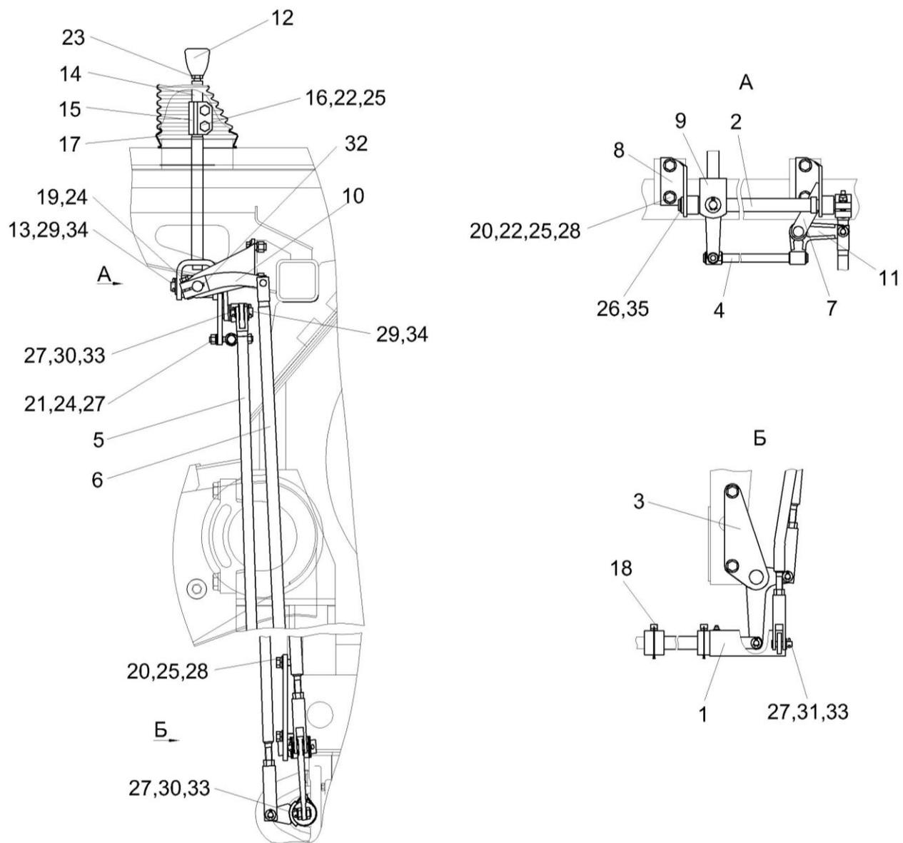
Рисунок 161 – Установка механизма управления коробкой диапазонов КЗК-12-0119040А-01
