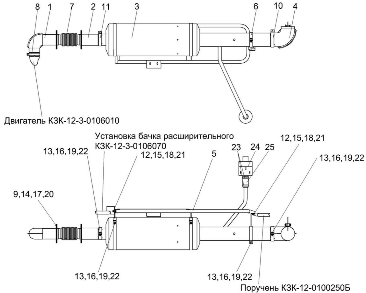
Рисунок 202 – Установка глушителя КЗК-12-3-0126800
