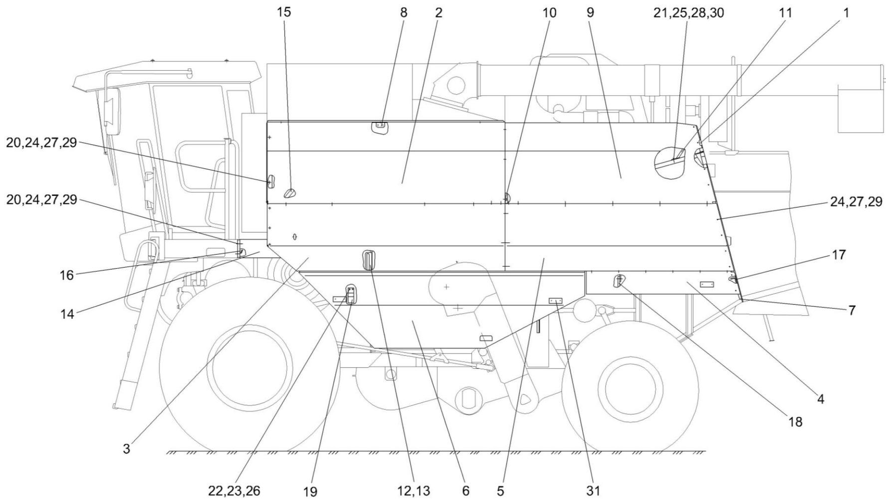
Рисунок 170 – Установка капотов и ограждения КЗК-12-0128000А (вид слева)
