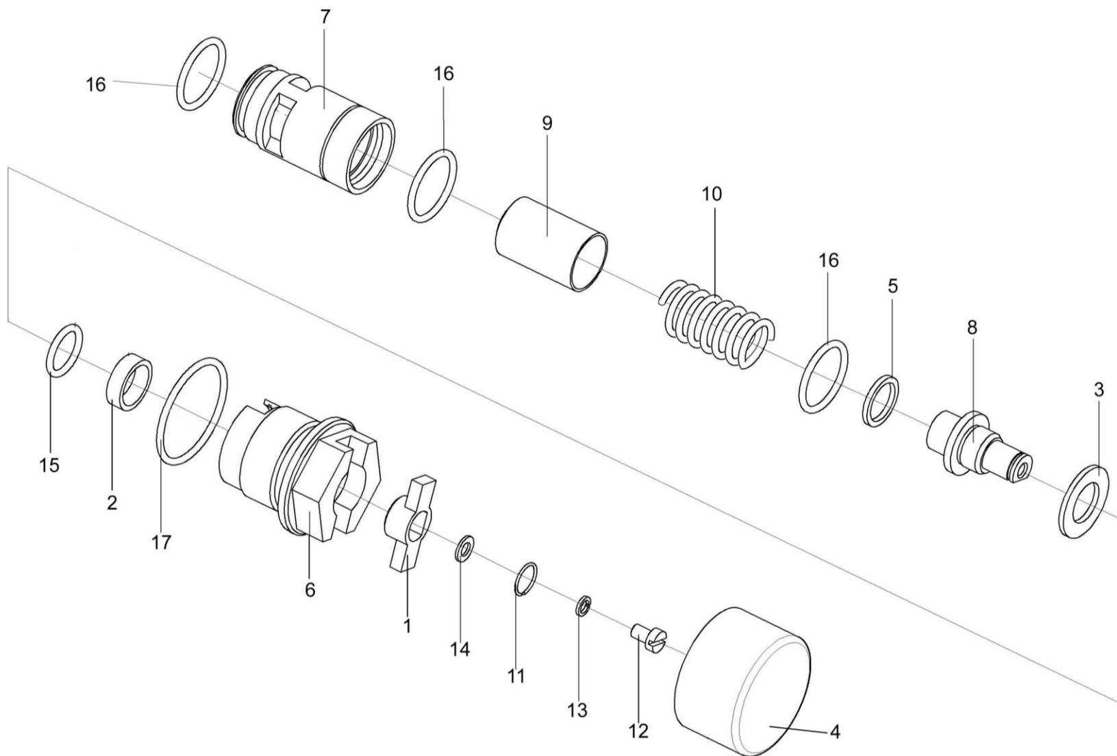
Рисунок 227 – Клапан-сигнализатор УЭС 0603660-01
