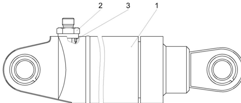
Рисунок 221 – Гидроцилиндр КЗК-12-0602020
