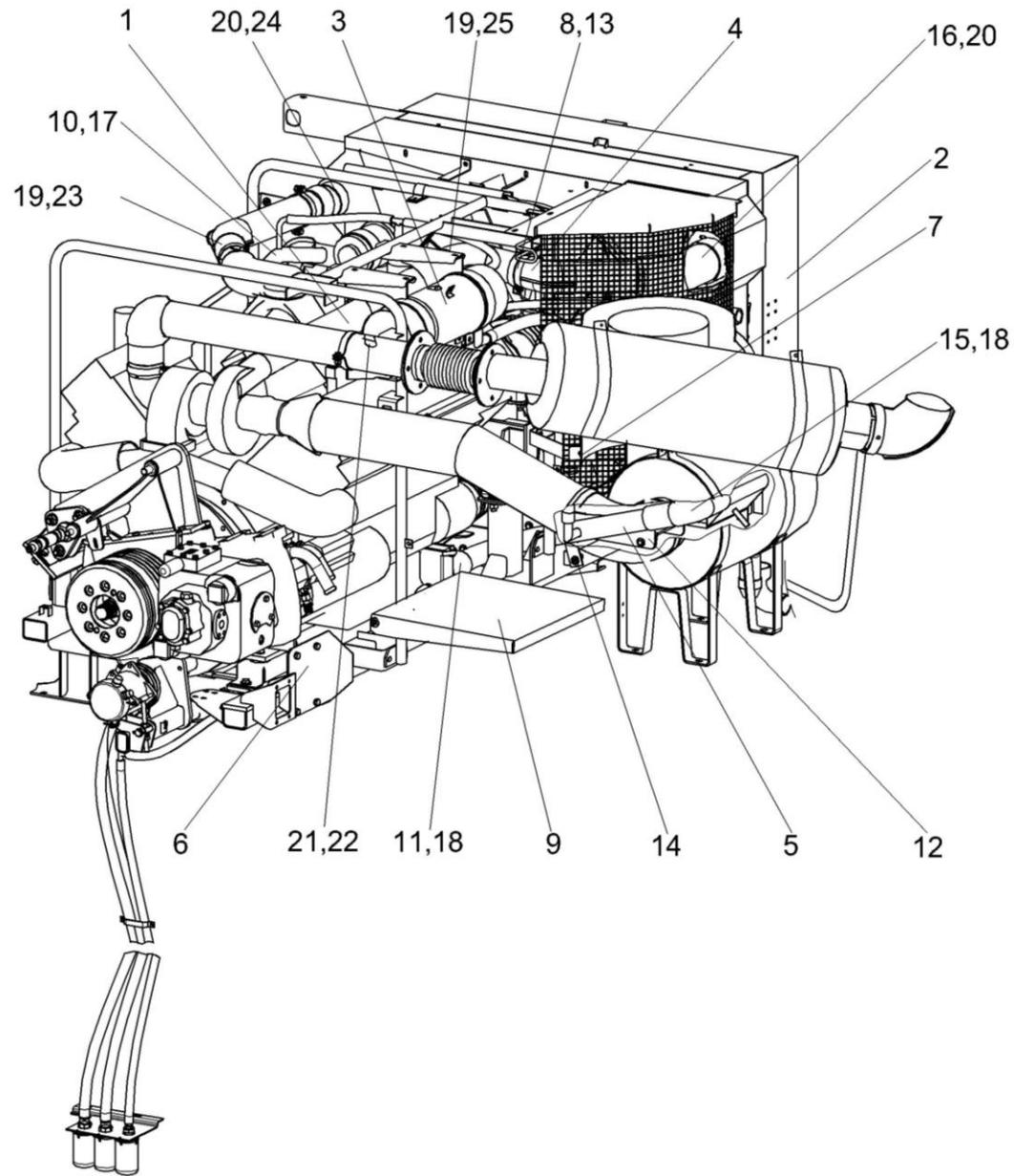
Рисунок 182 – Установка двигателя КЗК-12-3-0106000-01 (лист 1)
