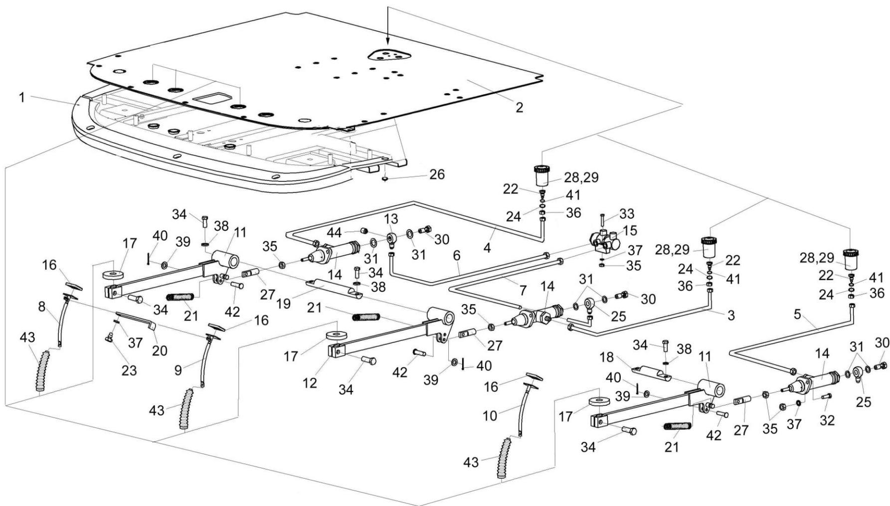
Рисунок 143 – Рычаги и трубопроводы площадки управления
