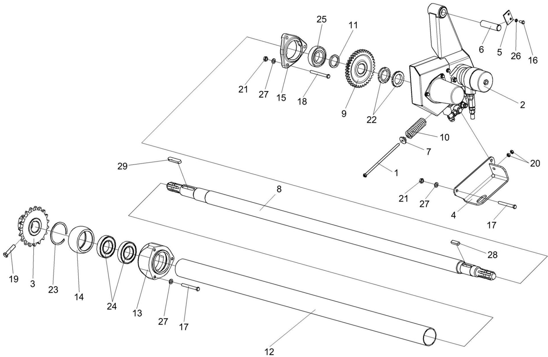
Рисунок 17 – Установка гидрореверса К3К-12-1804100
