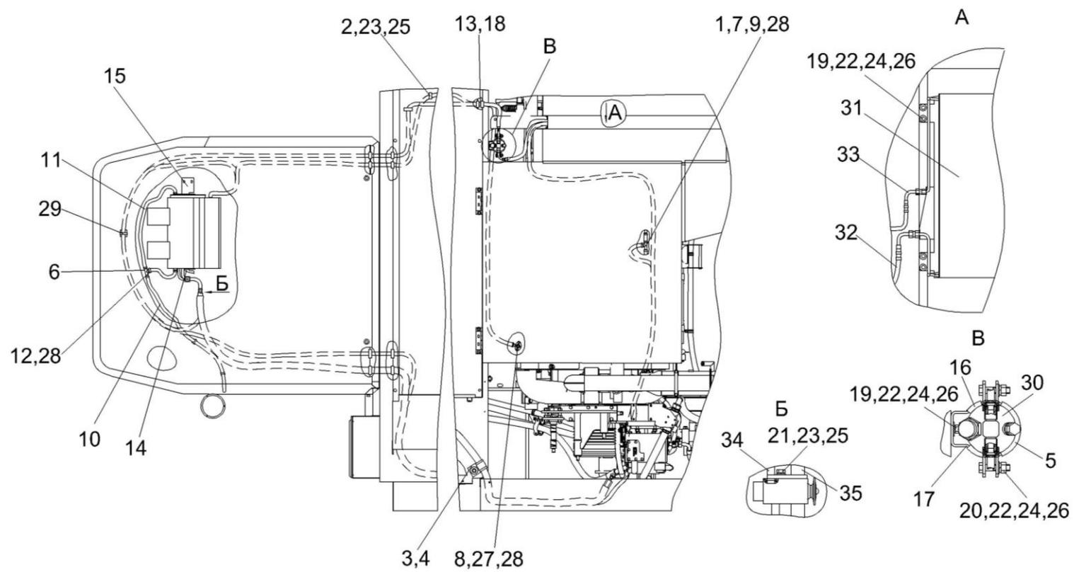
Рисунок 138 – Установка климатическая КЗК-12-0113000Б-03 (лист 1)
