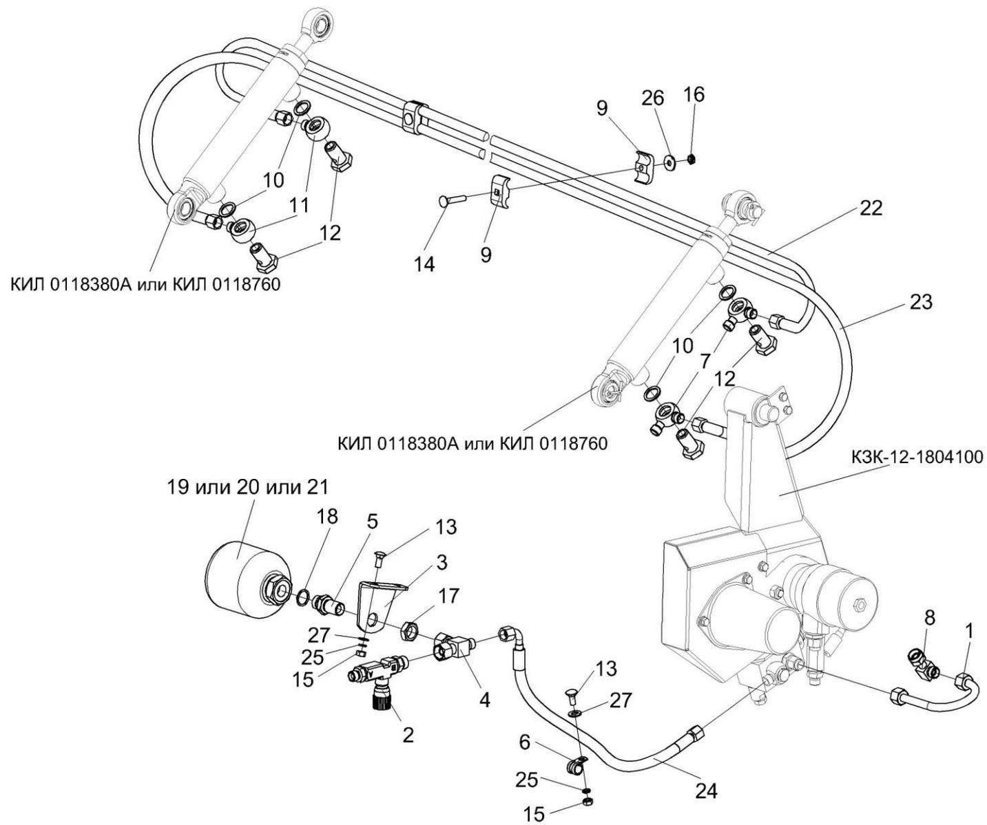
Рисунок 29 – Система гидравлическая камеры наклонной КЗК-12-1790000А
