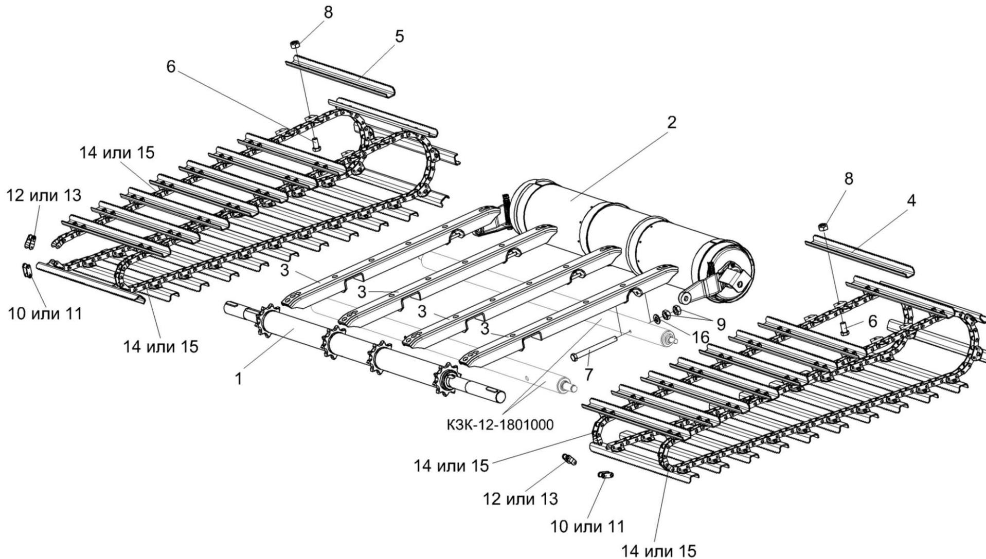
Рисунок 12 – Установка транспортеров КЗК-12-1807300 и КЗК-12-1807300-01
